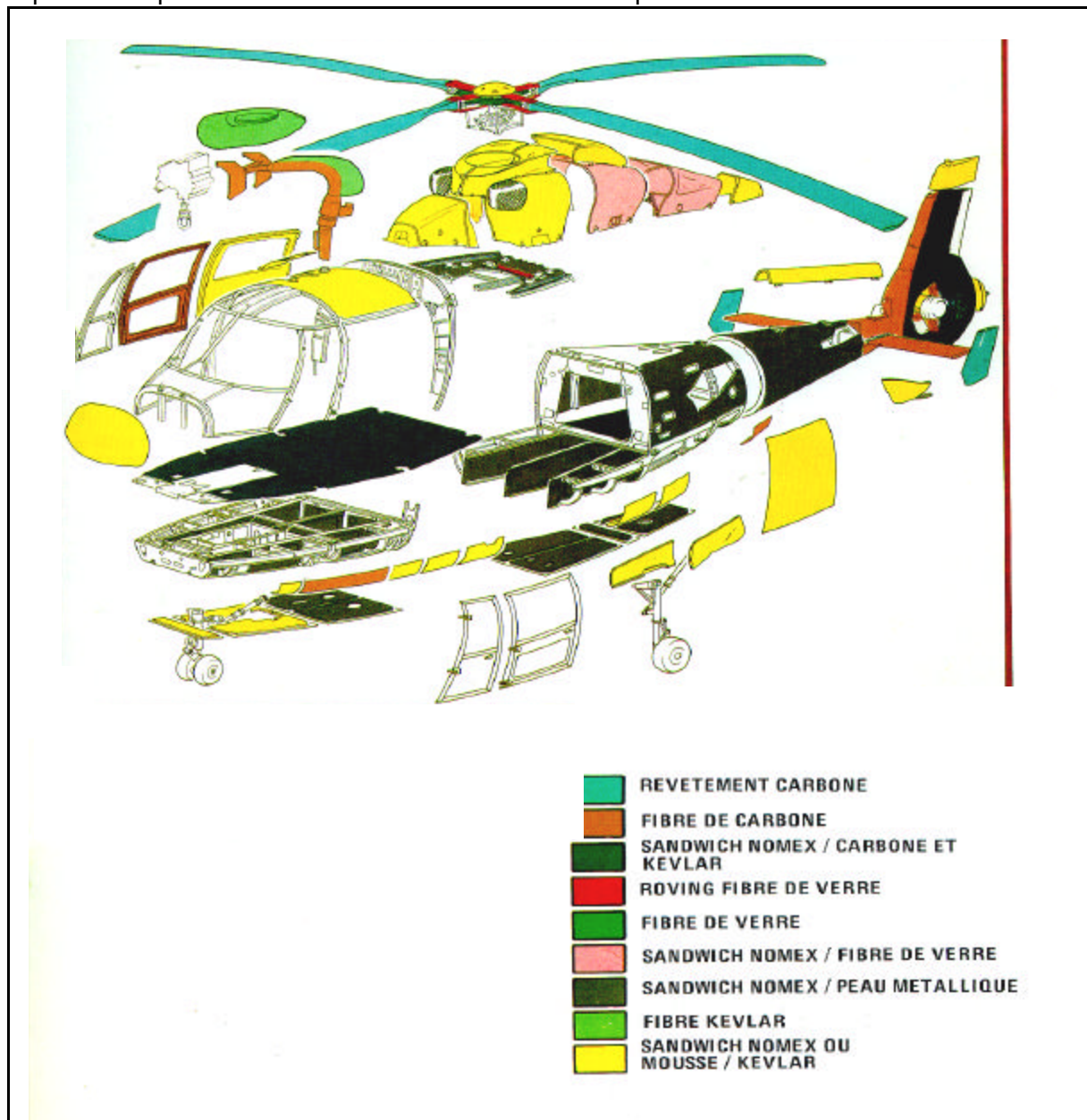
Figure N° 1-5 : Structure du Dauphin 2 (Document Aérospatiale)
