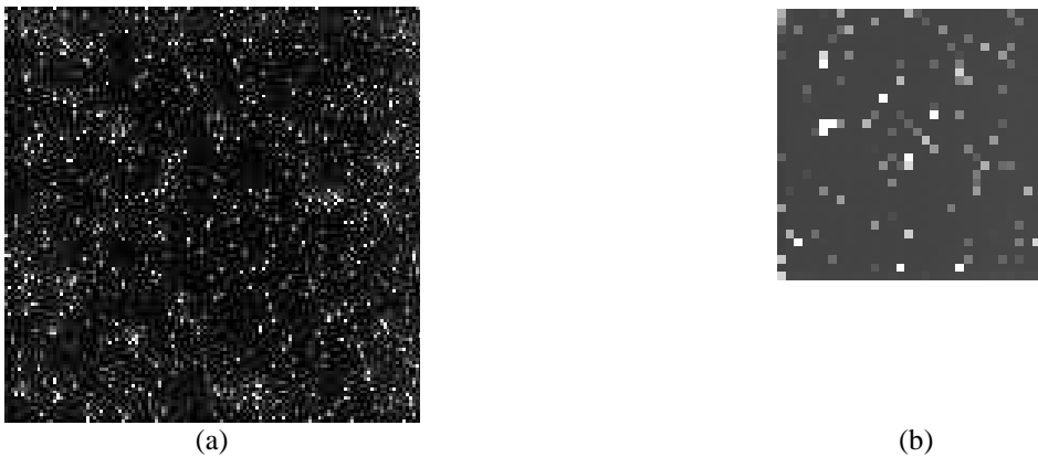
Figure IV.9 : Carte du courant d'obscurité à T=300\text{ K} (a) de la matrice 128 \times 128 pixels photoMOS réalisée sur une technologie AMS CMOS 0.6\mu m avec un temps d'intégration de 350\text{ ms} , et (b) d'une matrice 32 \times 32 pixels photoMOS réalisée sur une technologie AMS CMOS 1.2\mu m avec un temps d'intégration de 10\text{ ms} [22].
