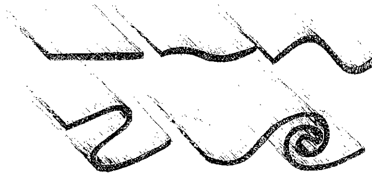
figure 1. 2 : Formation d'un tourbillon par le mécanisme d'instabilité de Kelvin-Helmholtz
