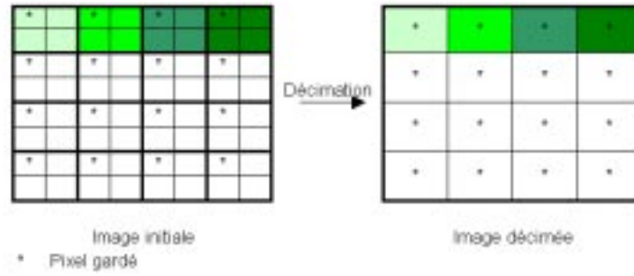
FIG. 3.1 – Exemple de décimation simple dans le cas d'un pas de décimation 2 \times 2 .
