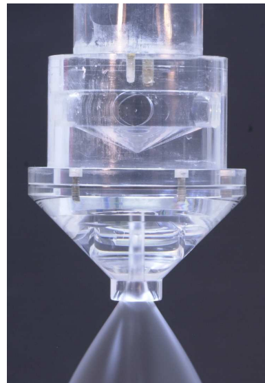
FIG. 3.14 – Vue du "bloc" primaire en fonctionnement. Nous pouvons distinguer le trou d'air qui s'est formé dans la chambre de swirl.
