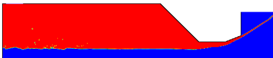
FIG. 5.43 – Écoulement diphasique interne dans l'injecteur primaire - Cas swirler n°1 injecteur n°1 - Re_w = 140000 - Le liquide est en rouge, l'air en bleu.
