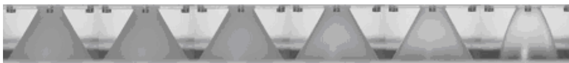
FIG. 6.12 – Ouverture du cône liquide pour la configuration "Swirler 1-Injecteur 4" en fonction du débit. De gauche à droite, Q = 2820, 2379, 1895, 1370, 920, 442 1/h.
