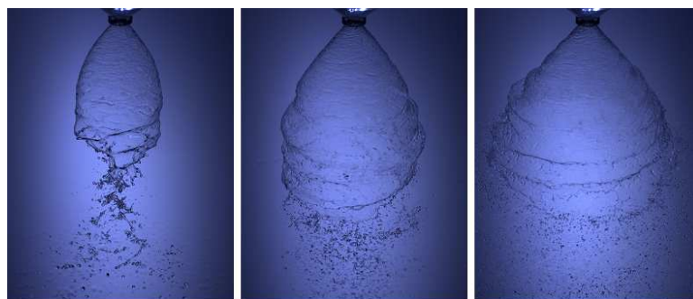
FIG. 5.39 – Ouverture et destabilisation de la nappe liquide - Circuit primaire - Maquette de l'injecteur complet
