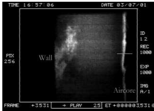
FIG. 3.17 – Traitement statistique des images acquises par caméra rapide - La méthode du "suivi de transition" : l'image est seuillée afin d'accentuer l'interface. Un segment repère représentant un nombre n de pixels est placé à cheval sur cette "transition". Pour chaque image, la distance en pixel entre le début du segment et la transition est déterminée. Cette procédure est ensuite répétée automatiquement pour toute la séquence.
