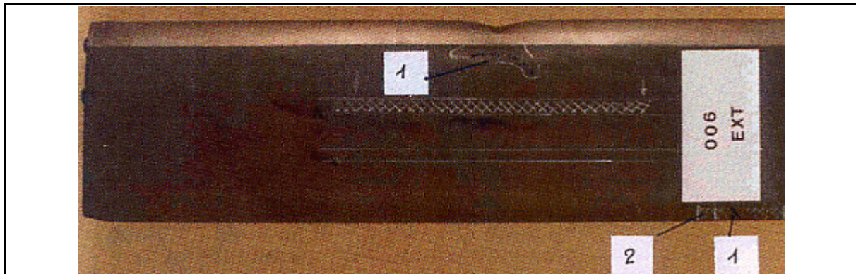
figure I-5 : Endommagement de l'extrados, pale 006 avec nervure
