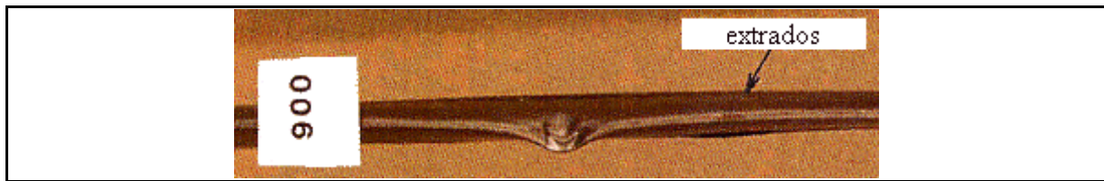
figure I-4 : Déformation du bord d'attaque
