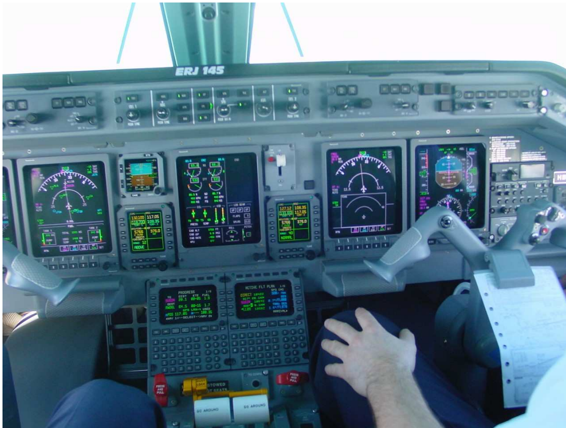
FIG. 1.2: Cockpit de nouvelle génération dit " glass cockpit " : ces interfaces, plus synthétiques, permettent à deux hommes seulement de contrôler le vol et les différents automates. Les pilotes disposent d'outils de diagnostic de pannes, et la mise en route de l'appareil est facilitée : plus besoin de mécanicien...
