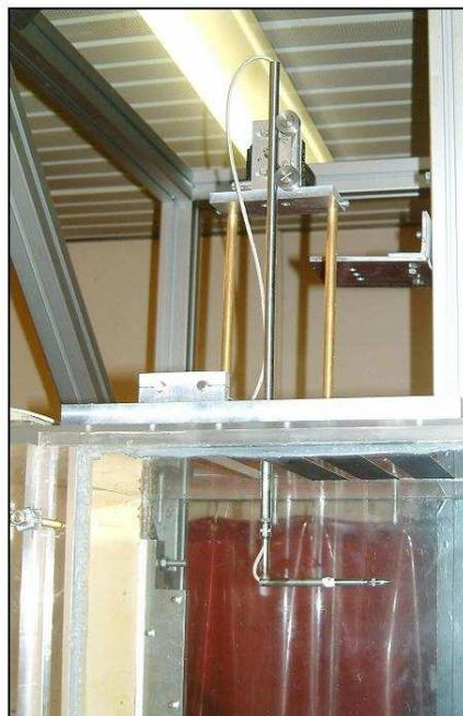
FIG. 3.9: Microphone mobile dans la soufflerie à retour basse vitesse.
