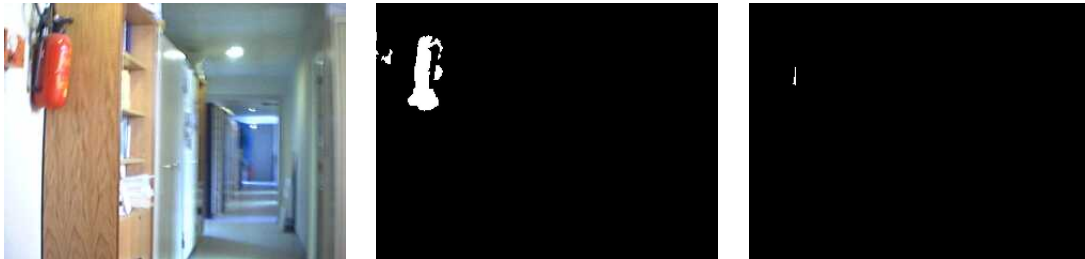
FIG. II.39 – Une image issue du LAAS dans laquelle seul le rouge "pur" est extrait et un objet est détecté grâce à une érosion.
