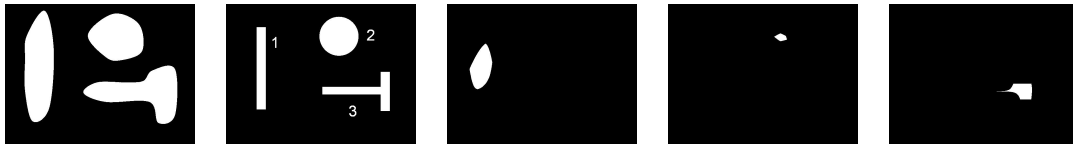
FIG. II.30 – Formes filtrées à l'aide d'éléments structurants particuliers.
