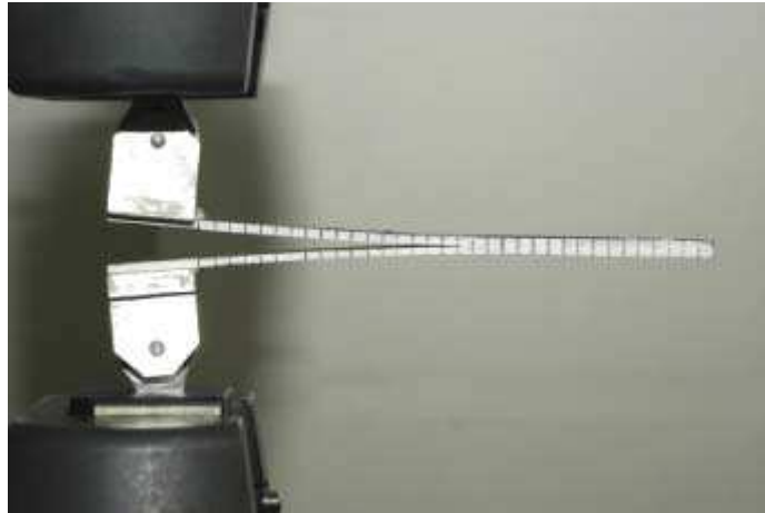
Figure IV - 17 : L'essai expérimental DCB
