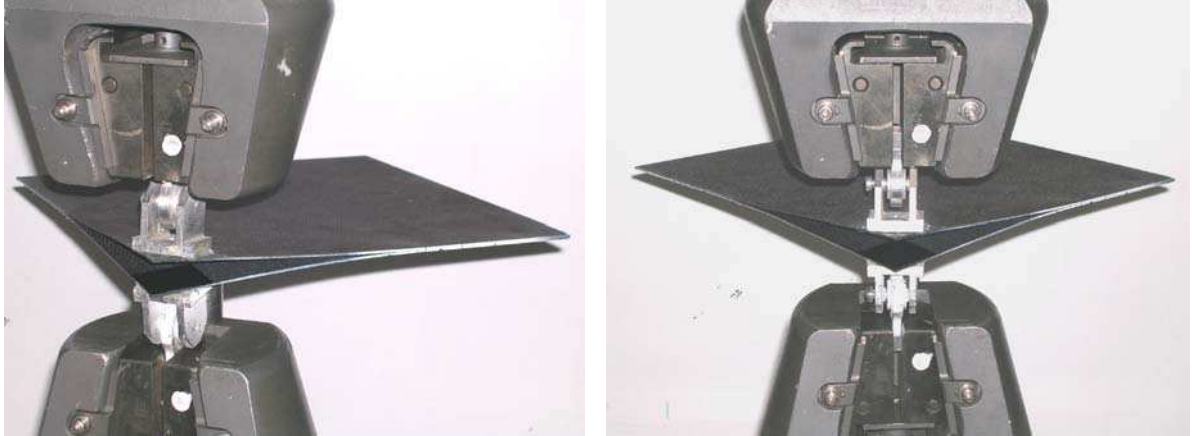
Figure V - 14 : Essai de séparation de la plaque composite
