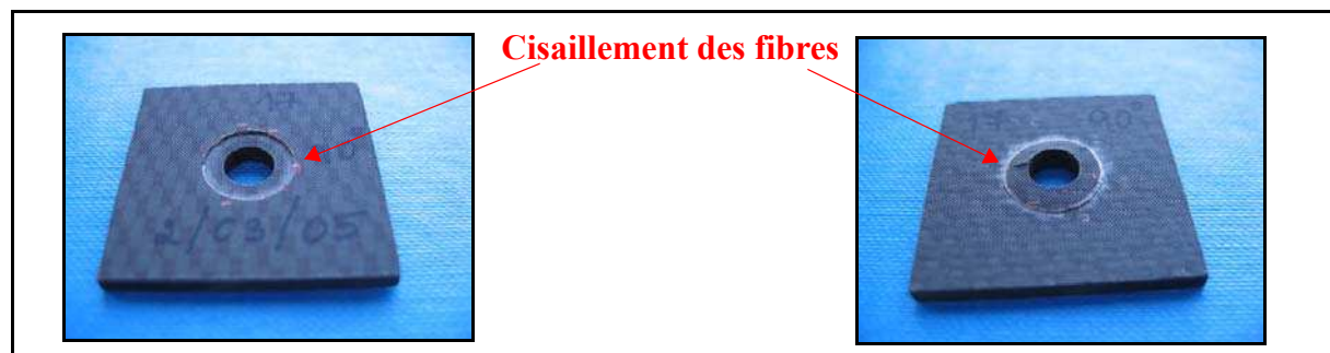
Figure 3-53 : Rupture finale de la peau avec poinçon 180°.
