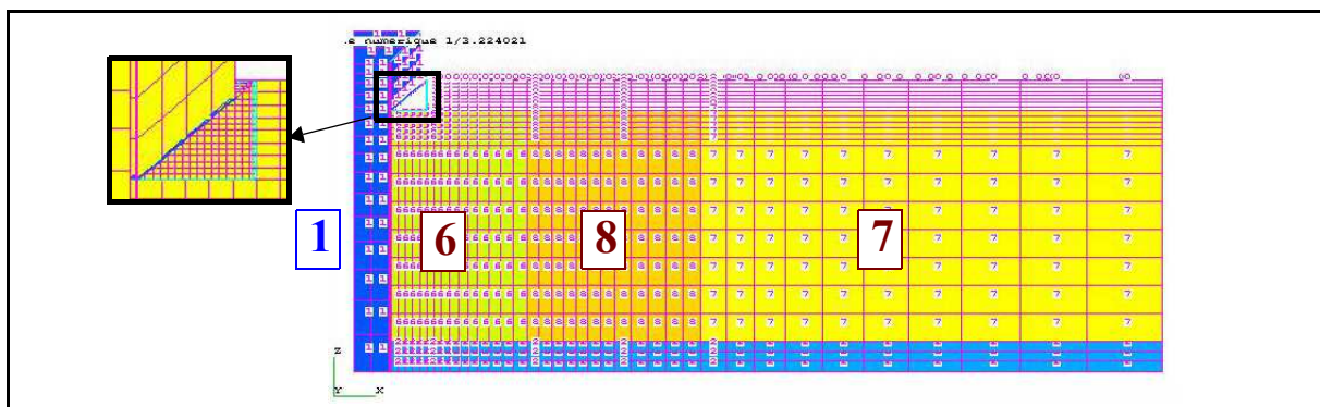
Figure 4-12 : Attribution des matériaux dans le modèle avec insert circulaire 30 mm.
