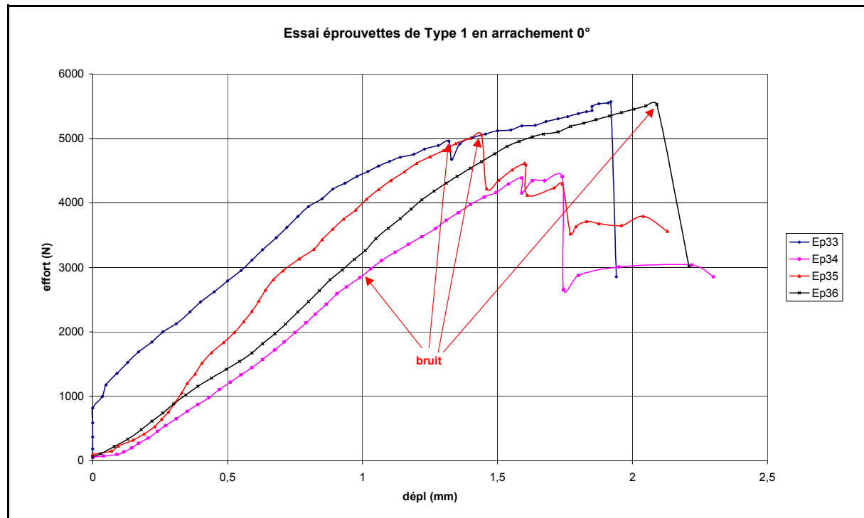
Figure N° 7 : Courbes d'essai éprouvette type 1 (potting 18 mm) en arrachement (0°).
