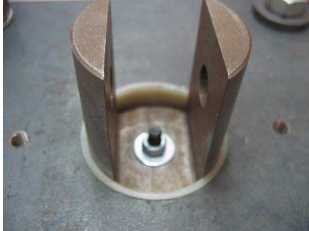
Figure 3-18 : Vue de la ferrure et de l'écrou après prétension.
