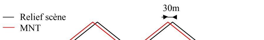
Figure 53: Comparaison entre le relief de la scène et le modèle numérique de terrain utilisé pour l'inversion.
