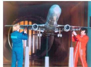
Figure 2.1. Schéma de la soufflerie F1 et Installation d'une maquette dans la veine d'essai
