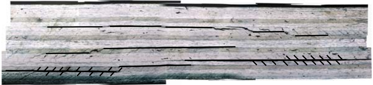
Figure III- 49 : coupe micrographique d'une plaque HM avec PT de 3.5 mm impactée à 14.2J
