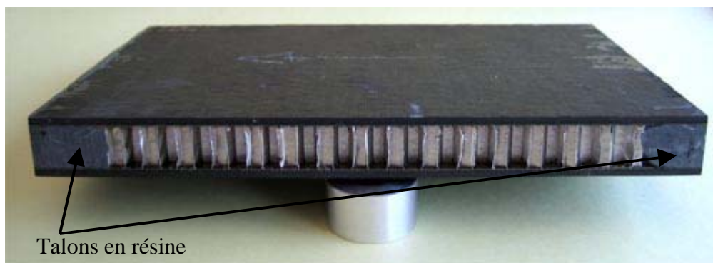
Figure IV- 2 : Photo d'une éprouvette sandwich de CAI
