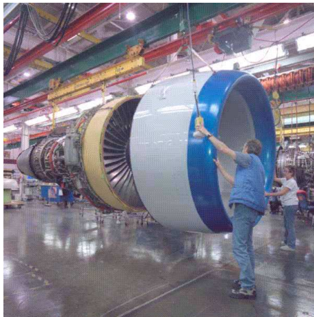
FIG. 2.21 – Installation de la nacelle sur le CF6 80C2 de General Electric. Ce moteur sera implanté sur le Boeing 767.
