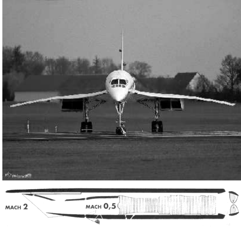
FIG. 2.14 – Le concorde : Les entrées d’air mises au point pour les quatre turbo-réacteurs Olympus 593/610 (Rolls-Royce/Snecma), les tuyères modulables à la sortie, permettent au Concorde, au delà de Mach M = 1.7 , de voler sans post-combustion. L’Olympus est le premier moteur civil à avoir été homologué pour utilisation continue à Mach 2. (Photo : Philippe Noret, dessin : www.concorde-jet.com)
