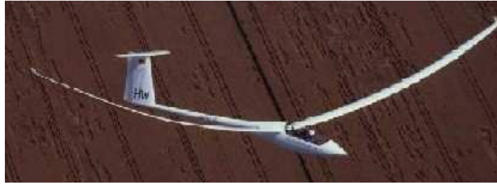
FIG. 3.7 – Planeur eta (allongement \lambda = 51.33 ) : Les moments de flexion voilure peuvent déformer considérablement l'aile. Ceci est d'autant plus remarquable sur les avions de grand allongement \lambda , tels que les planeurs. (Photo : Gerhard Marzinzik - Arokurier magazine - http://www.leichtwerk.de/eta/en/gallery/photos.html )
