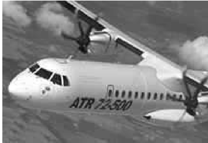
FIG. 3.16 – ATR 72 : Le “capuchon aérodynamique” au niveau de la liaison voilure-fuselage est pour les ailes hautes, comptabilisé dans la masse voilure, alors que ce n’est pas le cas pour les ailes basses (ce qui correspondrait au ventre mou est comptabilisé dans la masse fuselage).
