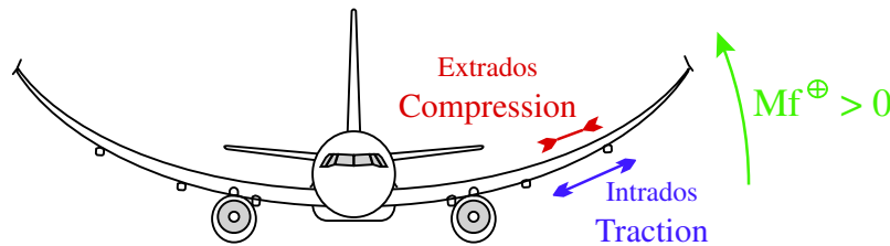
FIG. 3.6 – Pour un moment de flexion voilure positif M_f^{\oplus} , la semelle intrados est sollicitée en traction alors que la semelle extrados est sollicité en compression.
