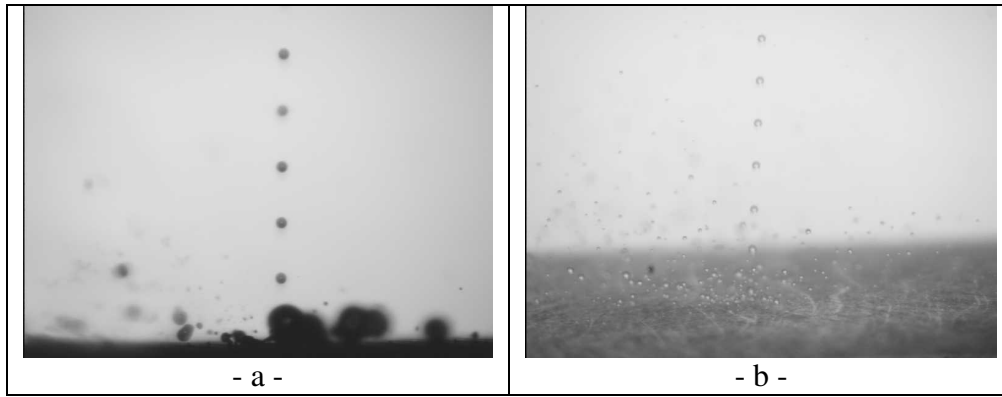
Fig. 6.4 : Impact de gouttes d'éthanol pour différentes valeurs du nombre de Weber.
