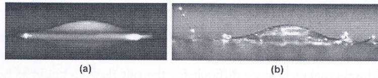
Fig. 2.9 : Influence de la rugosité de surface sur l'impact de goutte (même nombre de Weber, même liquide, paroi froide). Les conditions d'impact sont les mêmes dans les deux cas, mais en (a) la surface est lisse, en (b) elle est rugueuse [95]
