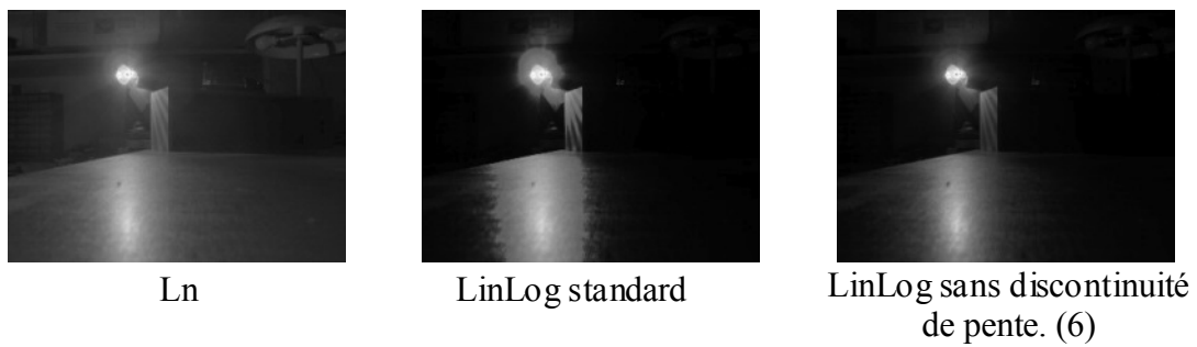
Figure II. 27.(c) : Comparaison des compressions log, linlog standard et linlog sans discontinuité de pente.
