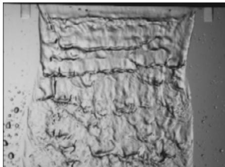
Figure B.42 : Visualisation du film liquide de face -  $h_l = 300\mu\text{m}$ ,  $V_g = 40\text{m/s}$ ,  $V_l = 1.8\text{m/s}$
