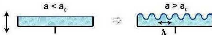
Figure A.27 : Développement d'onde de surface de longueur d'onde  $\lambda$  lorsque l'accélération est supérieure à l'accélération critique  $a_c$
