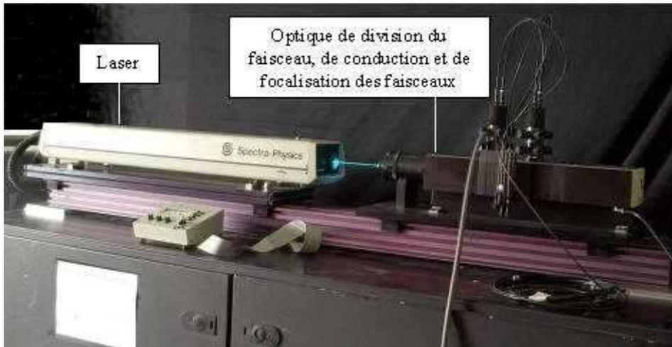
Figure B.29 : Système d'émission et de focalisation des faisceaux
