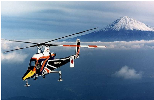
FIG. 1.6: L'hélicoptère bombardier d'eau Kaman K-MAX à double rotor engrené
