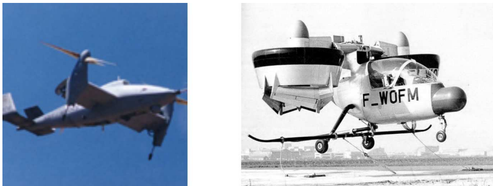
FIG. 1.8: le drone convertible Bell Eagle Eye - le Nord Aviation Nord500 à hélice carénée
