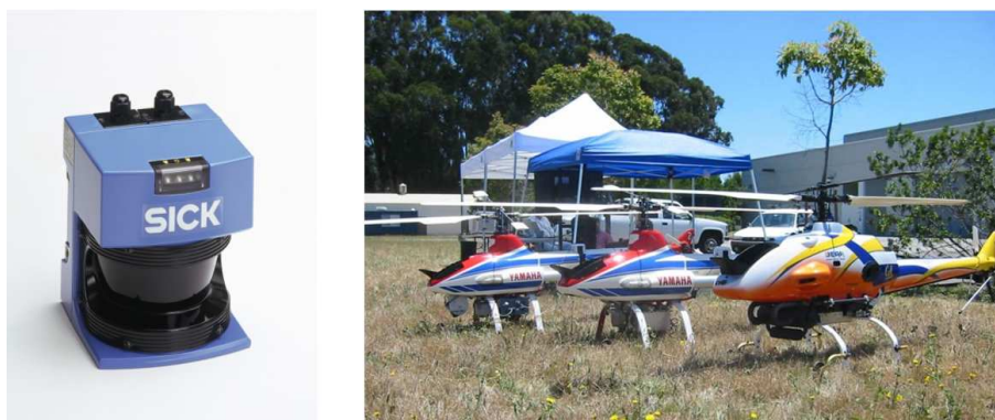
FIG. 1.14: le LIDAR SICK LMS200 - Les Yamaha Ursa Magna et Ursa Maxima de l'université de Californie à Berkeley équipés de Lidar
