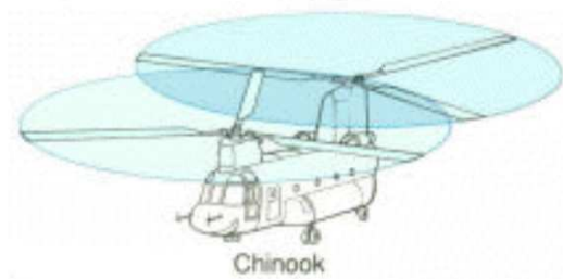
FIG. 1.5: Le Boeing CH47 Chinook à double-rotor en tandem
