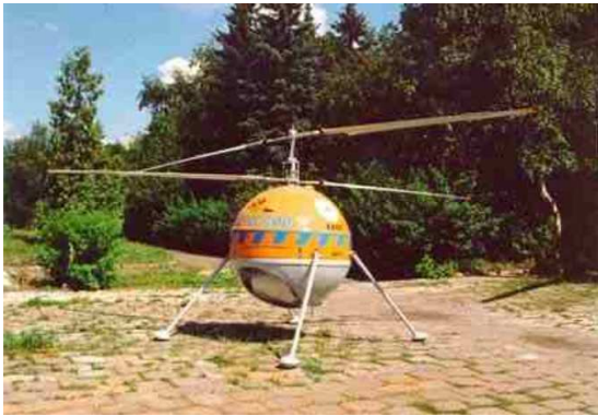
FIG. 1.4: Le Kamov KA-137 à double rotor étagé contrarotatif
