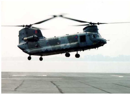
FIG. 1.5: Le Boeing CH47 Chinook à double-rotor en tandem
