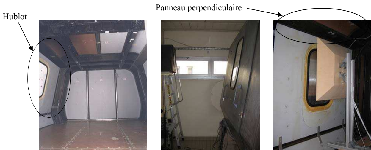
Fig. n°3.46: Configuration de l'expérimentation : tronçon VASCo (gauche), haut-parleur placé à 1m (centre), masque acoustique placé dans la cabine (droite).
