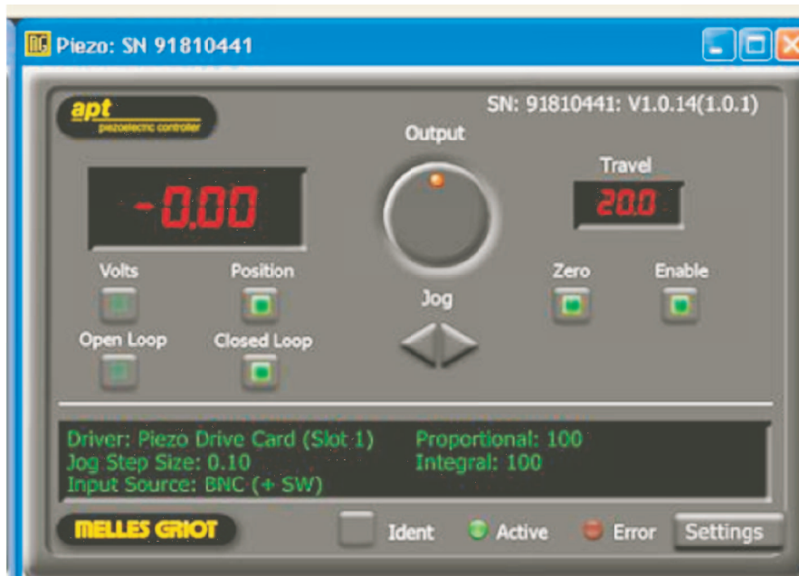
FIG. 4.24 – Interface de contrôle des translateurs piézoélectriques Melles Griot.
