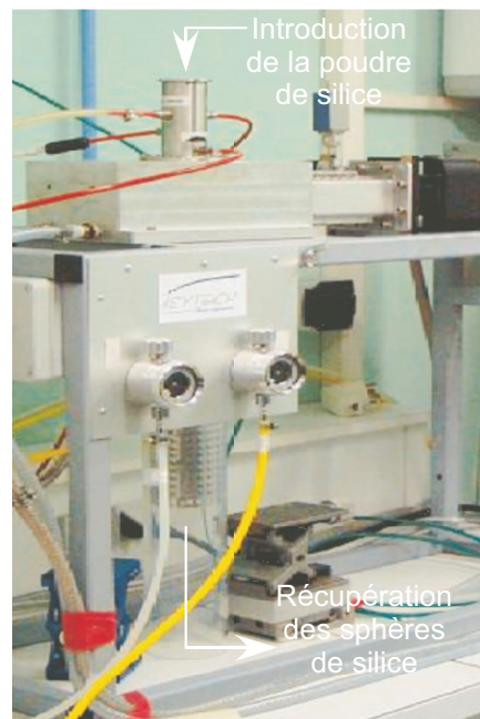
(a) Torche à plasma utilisée pour la fabrication des microsphères à l'ENSSAT, Lannion.
