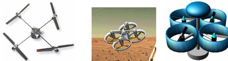
**Translation Verticale :** le contrôle vertical se fait par variation de la vitesse de rotation des rotors. Pour un vol stationnaire, la vitesse de rotation est la même que pour les 4 rotors, de façon à ce que la poussée globale des quatre rotors compense le poids de l'appareil. Pour changer l'altitude, on fait varier identiquement la vitesse de rotation des 4 rotors.
