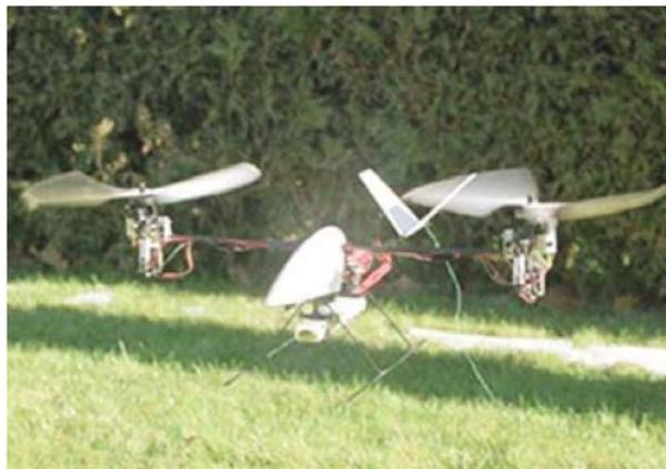
FIGURE 2.9 – Prototype de birotors pivotants réalisé par Gary Gress en 2003
