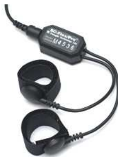
Fig. 53 : Capteur utilisé pour réaliser la mesure de la résistance électrodermale. Il se compose de deux électrodes apposées sur la pulpe de deux doigts afin de mesurer en continu le niveau de conductance électrodermale, l'individu étant considéré comme une résistance variable.
