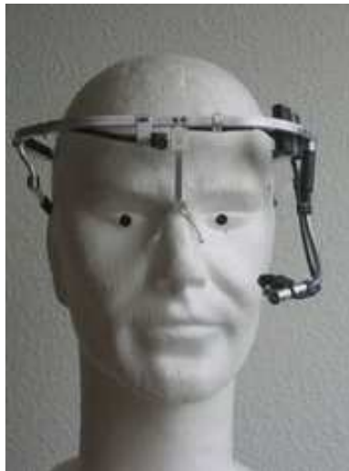
Fig. 56 : Oculomètre type L de la société Pertech ®. Il s'agit d'un oculomètre tête porté, contrairement aux caméras oculaires, il permet d'enregistrer l'activité visuelle même lorsque le participant détourne largement la tête de l'écran.
