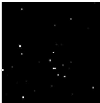
Figure 1-19 : Exemple de pixels sujets à un courant d'obscurité élevé issu d'un capteur CMOS en technologie 0.35µm
