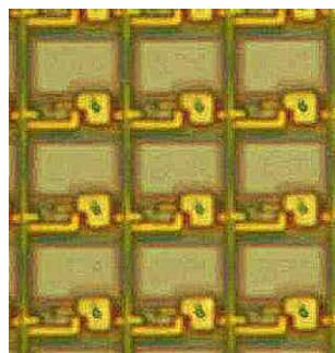
Figure 5-6 : Micro-photographie du pixel de référence du véhicule de test en technologie de génération CIS 0.18 \mu\text{m}
