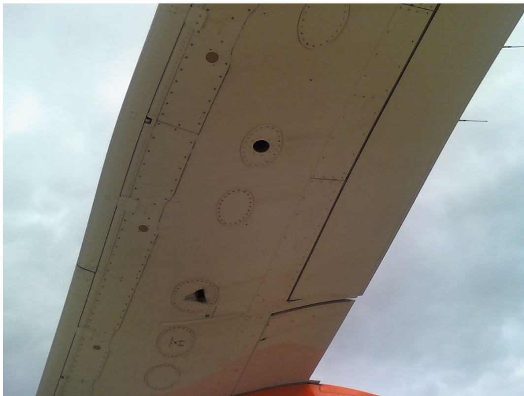
Figure 1 — Détail d'un A318, dessous de la voilure : cavité cylindrique. Photo de l'auteur.
