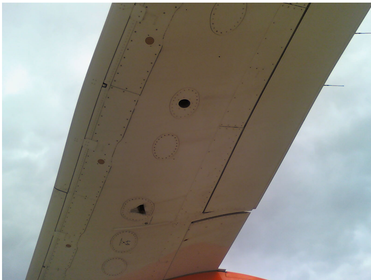
Figure I.7 — Détail d'un A318, dessous de la voilure : cavité cylindrique. Photo de l'auteur.
