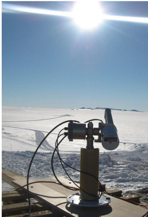
Figure 10. Photographie d'un héliophotomètre pointant vers le soleil.
