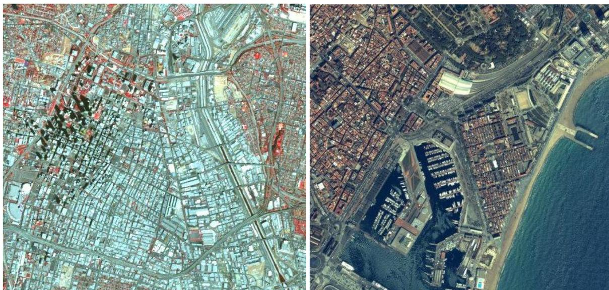
**Figure 4. A gauche, composition colorée en fausses couleurs d'une prise de vue à haute résolution spatiale (10m) de Los Angeles par l'instrument SPOT5. A droite, composition colorée en vraies couleurs d'une prise de vue à très haute résolution spatiale (4m) de Barcelone par l'instrument Ikonos (<http://www.satimagingcorp.com/gallery-ikonos.html>).**
