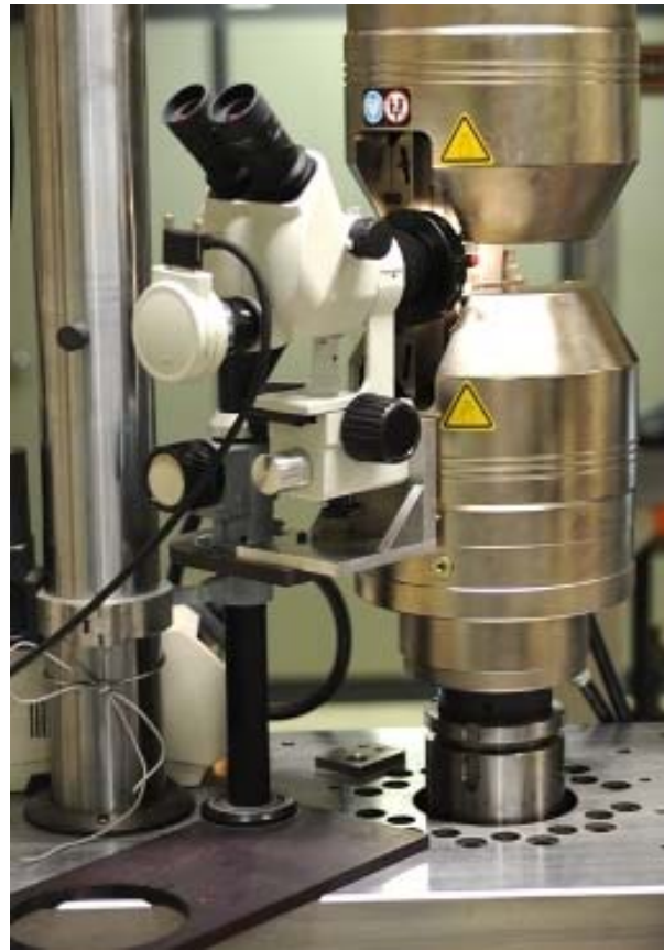
Figure 51 : Microscope optique pour observer les deux bords de l'éprouvette pendant les arrêts des essais
