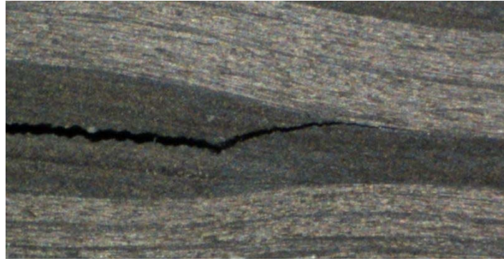
Figure 74 : Propagation d'un délaminage par rupture d'un pli désorienté
