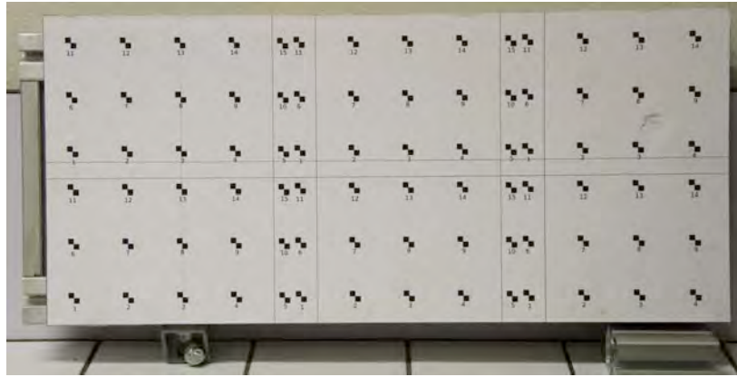
Fig 2.23 : Photographie du panneau utilisé pour réaliser la calibration des champs de vitesse PIV
