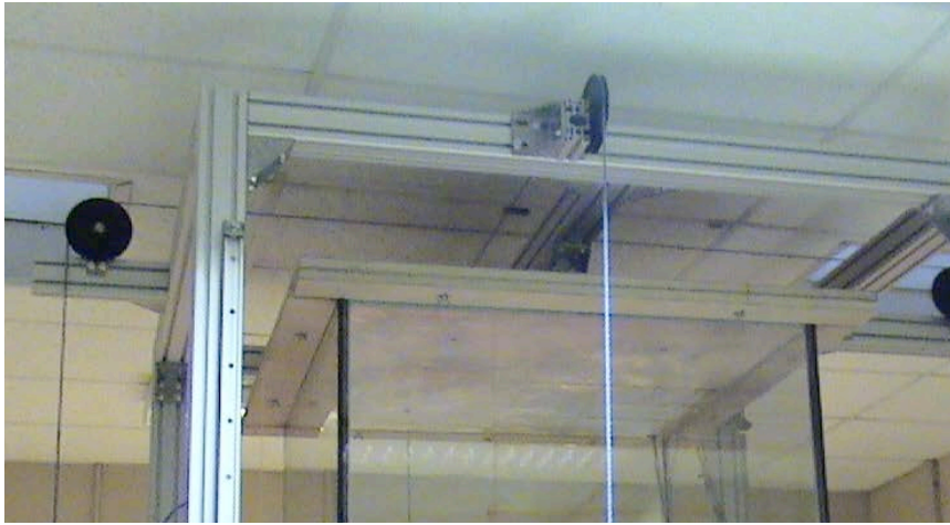
Fig 2.9 : Photographie représentant le plafond de la cuve entouré par les 4 parois verticales en verre
