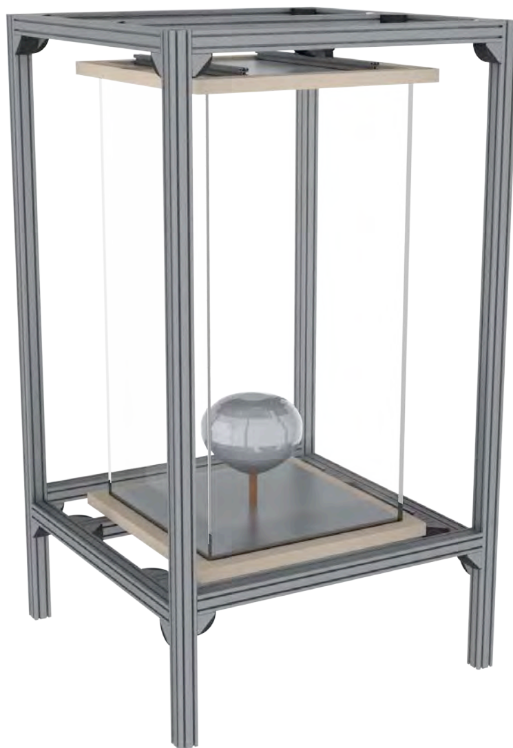
Fig 2.1 : Représentation 3D de la cuve avec la maquette chauffante placée à l'intérieur
