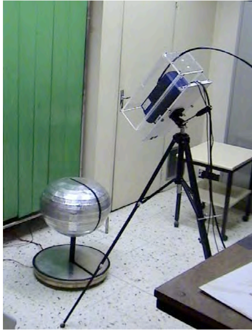
Fig 2.24 : Photographie prise pendant l'expérience de thermographie infrarouge avec la caméra qui filme la surface de la maquette avec un angle de -45^\circ par rapport à l'horizontale
