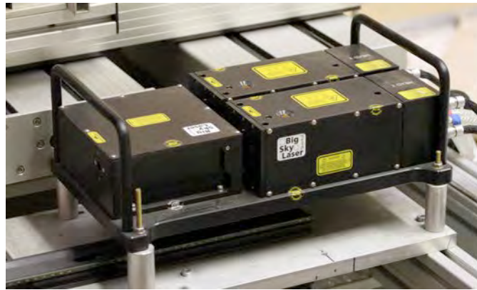
Fig 2.17 : photographie du laser Quantel de type Nd:YAG
