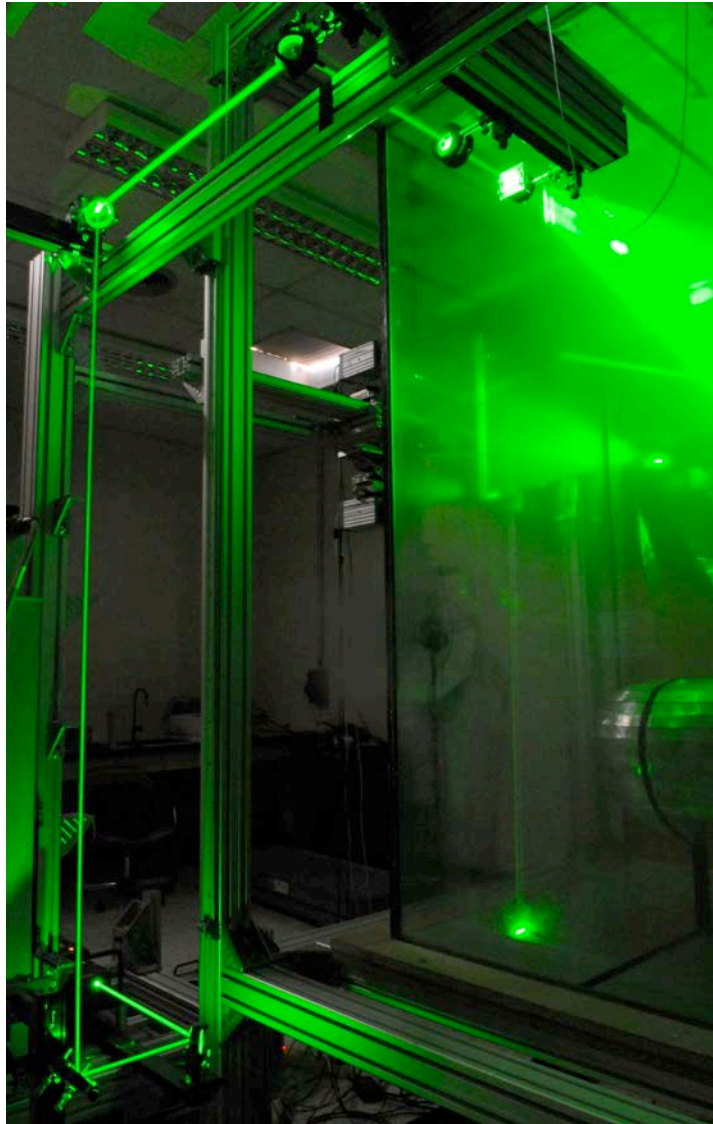
Fig 2.22 : Photographie du chemin optique laser et de la nappe laser pendant une acquisition PIV
