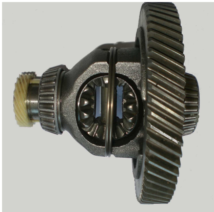
FIGURE 2.10 – Photographie du différentiel de voiture
