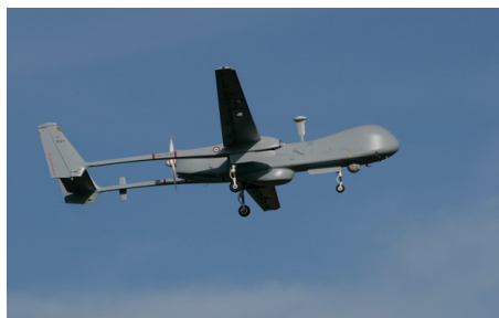
(a) Le Raven, d'AeroVironment, capable d'accomplir une mission en complète autonomie, dont la navigation est basée sur des points GPS. (b) Le Harfang, d'EADS. En cas de perte de communication avec les opérateurs, il retourne à son point de départ.
