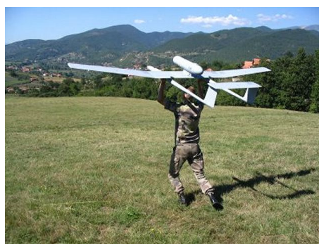
(d) Le RQ-4 Global Hawk de Northrop Grumman dont la navigation peut être autonome, reposant sur GPS. (e) Le Drone de Reconnaissance Au Contact (DRAC) d'EADS capable de vols et d'atterrissages en complète autonomie.
