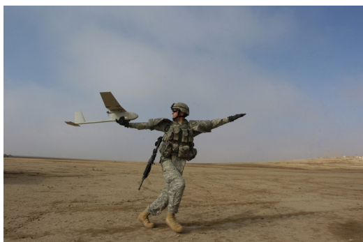
(a) Le Raven, d'AeroVironment, capable d'accomplir une mission en complète autonomie, dont la navigation est basée sur des points GPS. (b) Le Harfang, d'EADS. En cas de perte de communication avec les opérateurs, il retourne à son point de départ.
