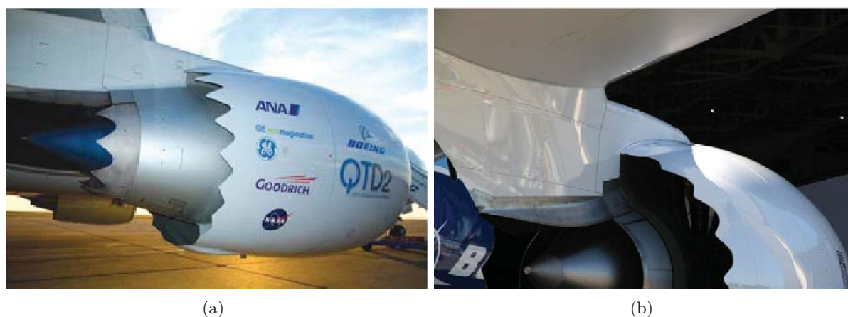
Figure 3 — Exemple d'application des chevrons a) Boeing Quiet Technology Demonstrator. b) Boeing 787, Rolls-Royce Trent 1000.
