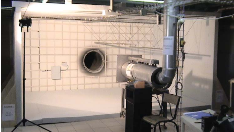
Figure F.1 — Photographie de l'installation acoustique du Réchauffeur 113.
