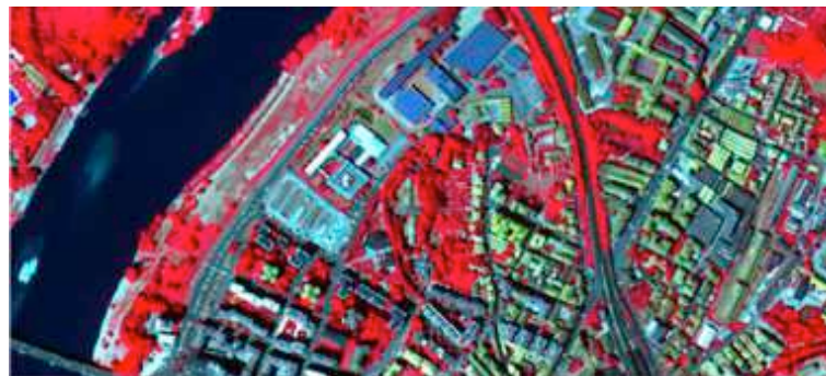
FIG. 1.4: La représentation image, la plus intuitive. L'exemple ci-dessus est une composition colorée faite à partir de trois bandes d'une image hyperspectrale (proche infra-rouge : 830 nm, rouge : 690 nm et vert : 550 nm).
