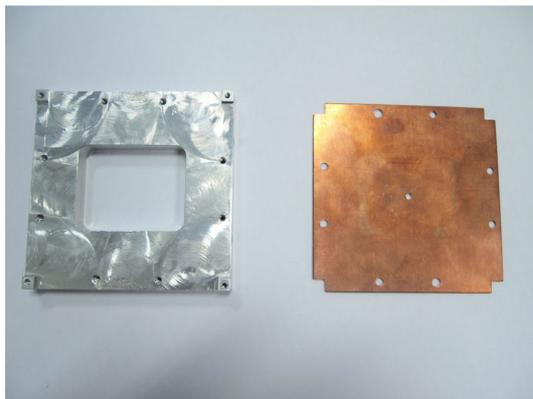
(a) Photo des deux pièces qui constituent le plan de masse de l’antenne.
