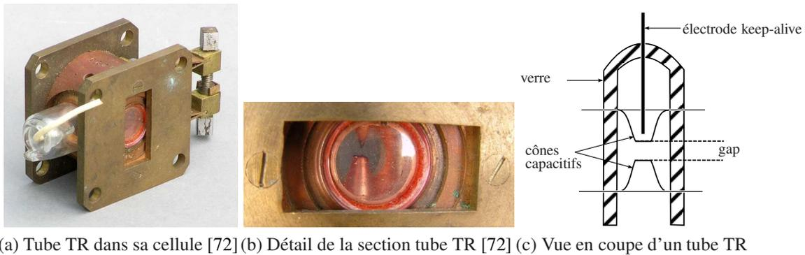
(a) Tube TR dans sa cellule [72] (b) Détail de la section tube TR [72] (c) Vue en coupe d'un tube TR
