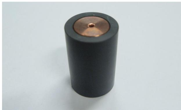
(a) Photo de la cathode avec couverture en PVC.
