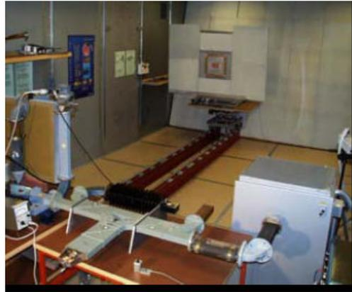
FIGURE 2.25 – Dispositif de mesure du dispositif limiteur plasma basé sur une antenne fente résonante.
