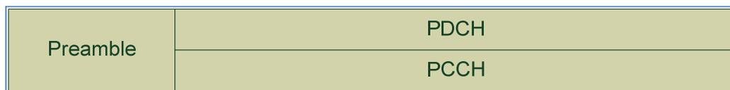
Figure 4 : Structure du paquet E-SSA
