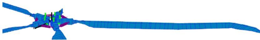
FIGURE 3.2: Maillage éléments-finis 1D d'une pale
