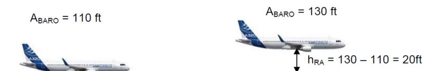
FIGURE 5.17 – Le baromètre en mode relatif au décollage
