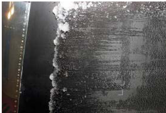
FIGURE 1.3 – Exemple de formation de runback ice [96]. L'écoulement est dirigé de gauche à droite, et la zone protégée se trouve à gauche.
