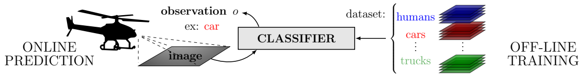
FIGURE 3 – Exemple d’une méthode d’observation dans le contexte robotique : le robot, ici un drone, est équipé d’une caméra et utilise un classifieur (classifier) calculé à partir d’une base de données d’images (comme NORB , cf. figure 4). Le classifieur est généré avant la mission (hors-ligne, off-line) avec une base de données d’images (cf. partie droite de l’illustration, dataset ), et la sortie du classifieur est utilisée lors de la mission (en ligne, online) comme une observation pour l’agent (cf. partie gauche de l’illustration). Ici, les observations sont donc générées par un algorithme de vision artificielle.
