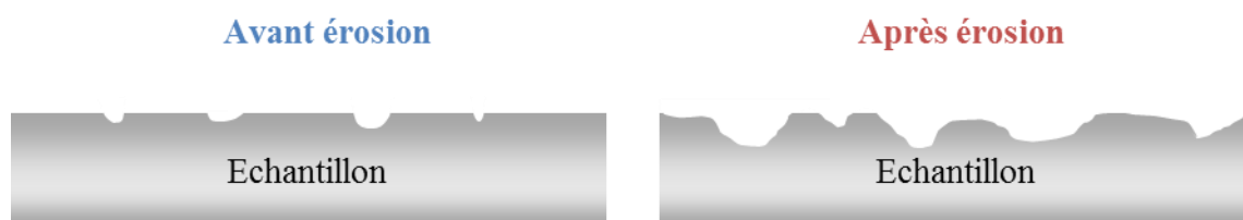
Figure 79. Schéma de la topographie de la surface de l'échantillon d'argent avant et après le protocole d'érosion
