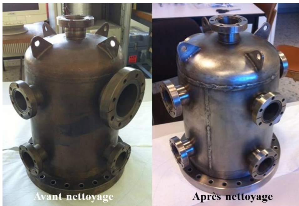
Figure 32. CELESTE avant et après nettoyage
