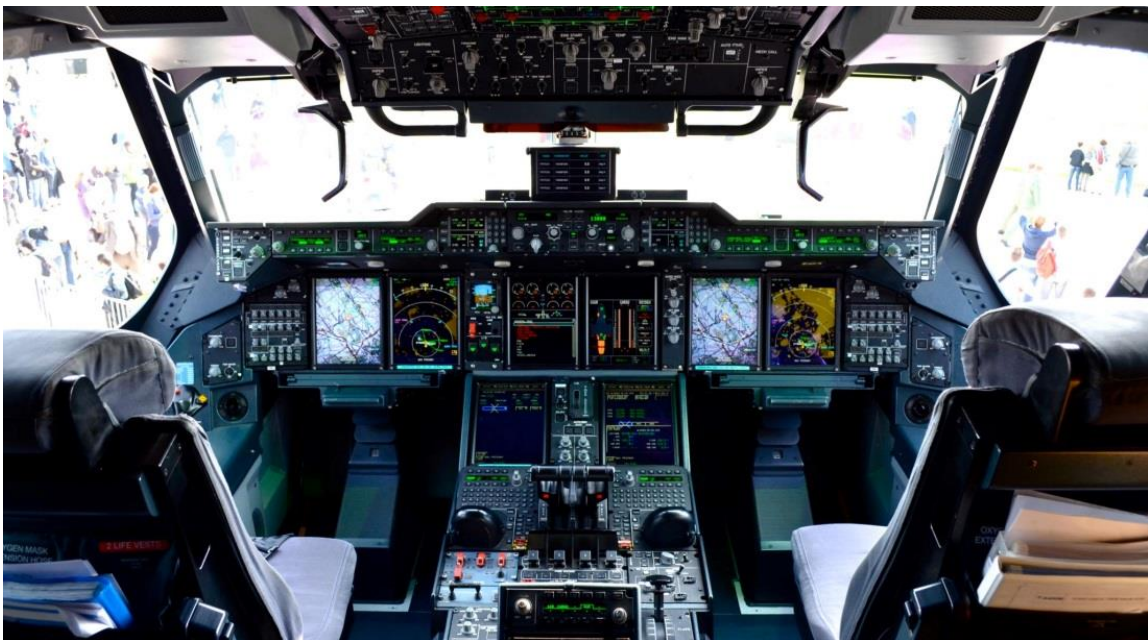
Figure 1. Cockpit d'un A400M. On constate la taille et la complexité visuelle de l'interface homme-machine. Par ailleurs les pilotes doivent également prendre en compte les communications radios, les alertes visuo-auditives et tout ceci dans le bruit de fond généré par le vol.
