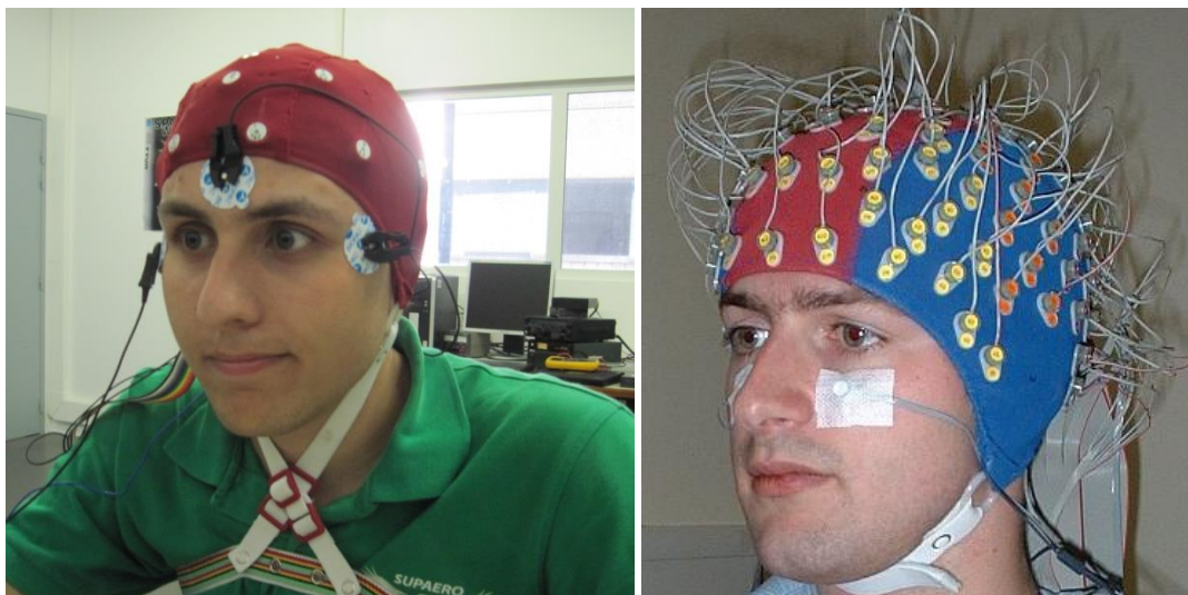
Figure 7. A gauche, un sujet équipé d'un EEG Biopac à 19 électrodes. A droite, un sujet équipé d'un bonnet de 128 électrodes Biosemi .
