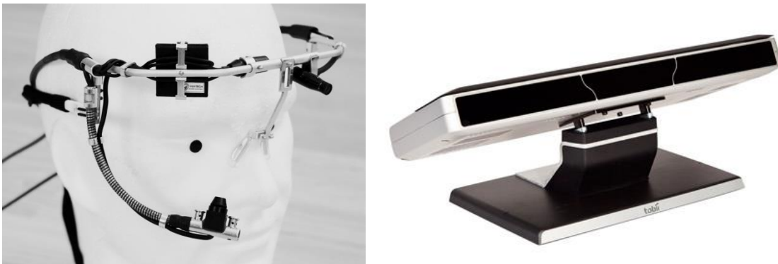
Figure 11. A gauche, un eye-tracker Pertech, avec une caméra frontale filmant le champ de vision, et une caméra qui vient filmer l'œil du sujet. A droite, un eye-tracker fixe Tobii, qui se place sous l'écran présentant la tâche.
