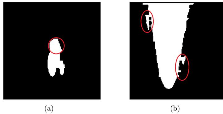
FIGURE 4.6 – Illustration de l’impact de la composition du sol sur la détection des panaches de gaz. (a) Scénario 1b pour la bande MWIR. (b) Scénario 2b pour la bande MWIR. Les panaches de gaz couvrant des structures de matériaux émissifs sont plus facilement détectables.
