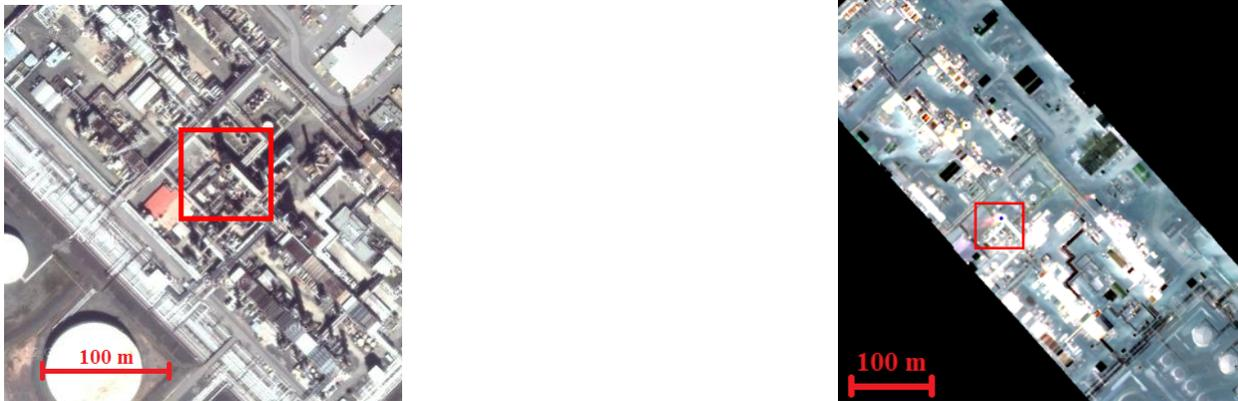
FIGURE 3.3 – Images aériennes de la raffinerie Jean Gaulin au Québec. L'image de gauche est issue du site de Google Map. L'image de droite est une image RGB des bandes spectrales :  $8.59$ ,  $10.35$  et  $11.24 \mu\text{m}$  acquises par l'instrument de Telops. Le cadre rouge représente l'imagerie sur laquelle le SAM a été appliqué.
