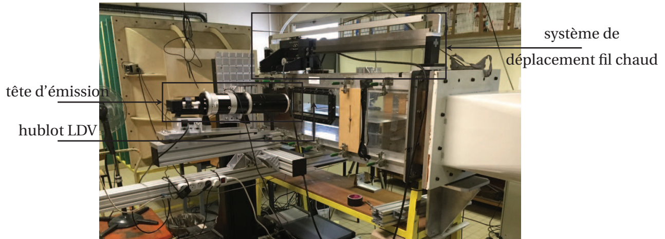
FIGURE 7.4 – Montage autour de la soufflerie TRIN2.
