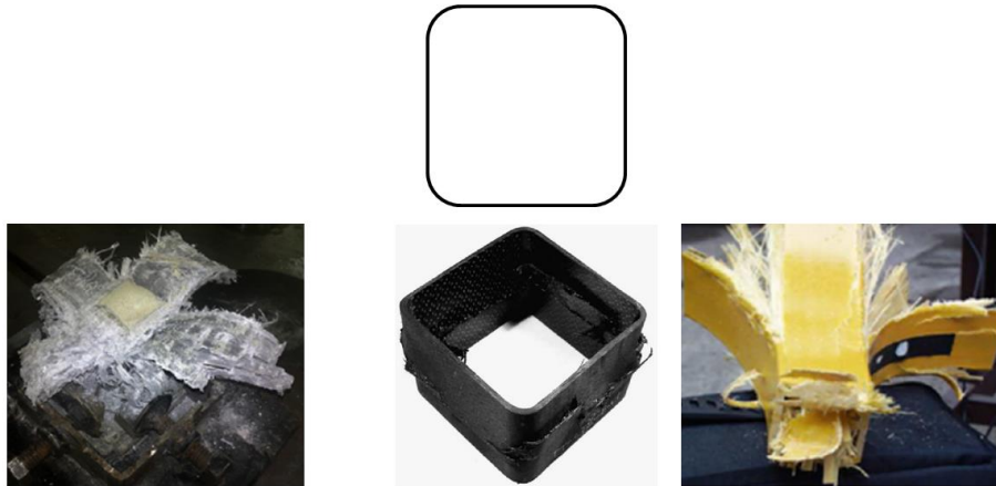
a) Composite fibre de verre à matrice polyester avec mousse [Oth16]
