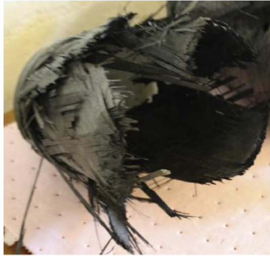
Figure I-23 : Endommagement d'un réservoir composite [Leh15]
