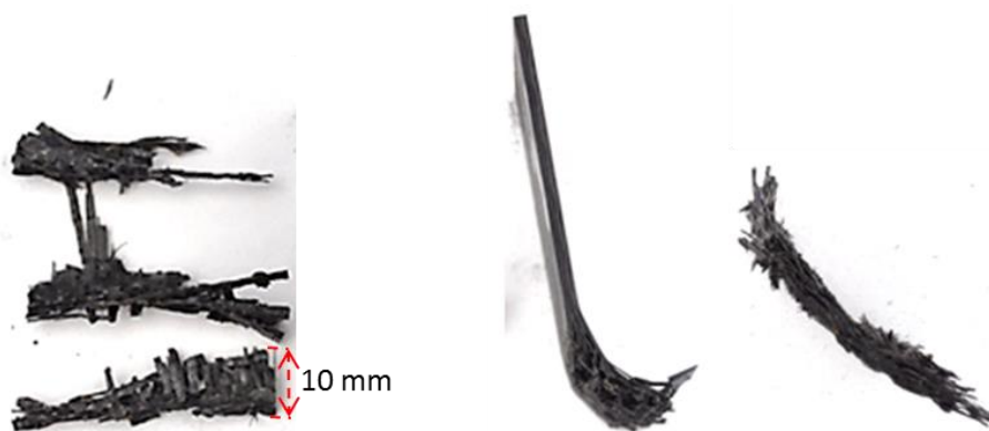
(a) 1 er comportement d'écrasement (débris entre 5 et 10 mm de hauteur)
