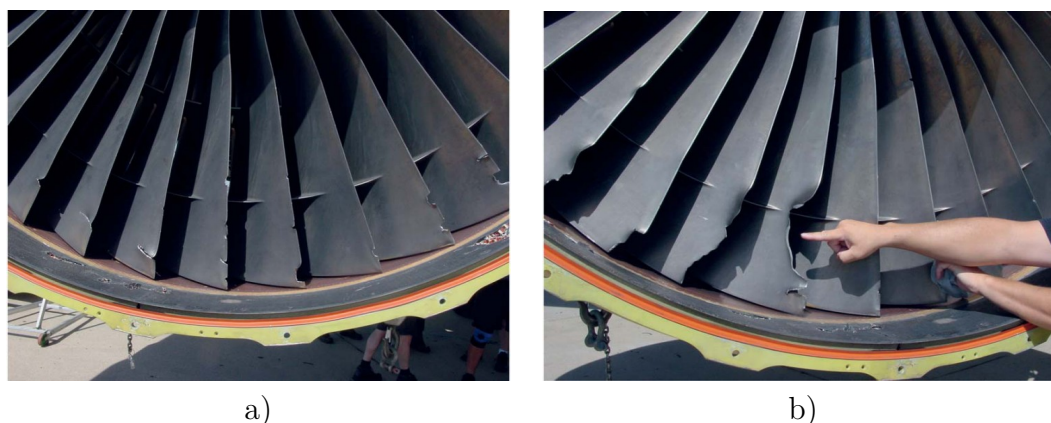
FIGURE I.2 – Ingestion d’oiseaux dans les moteurs des avions menant à l’endommagement des ailettes : a) Plusieurs fissures à travers des ailettes [38] et b) déformation plastique large [38]
