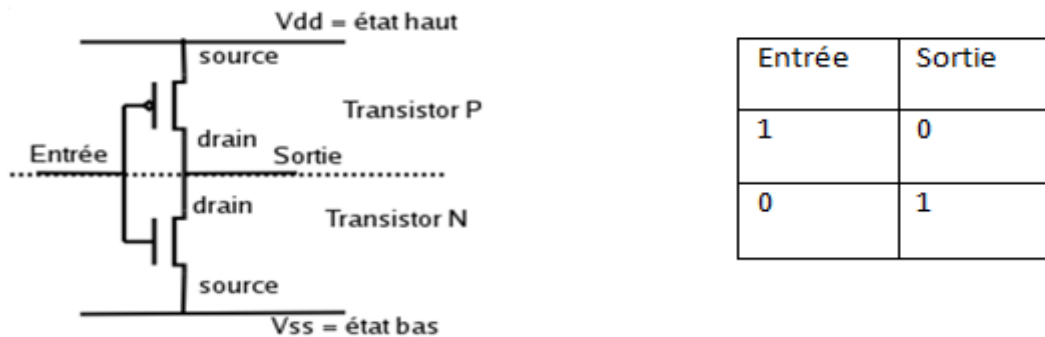
Figure 1.3: Schéma et table de vérité de l'inverseur CMOS
