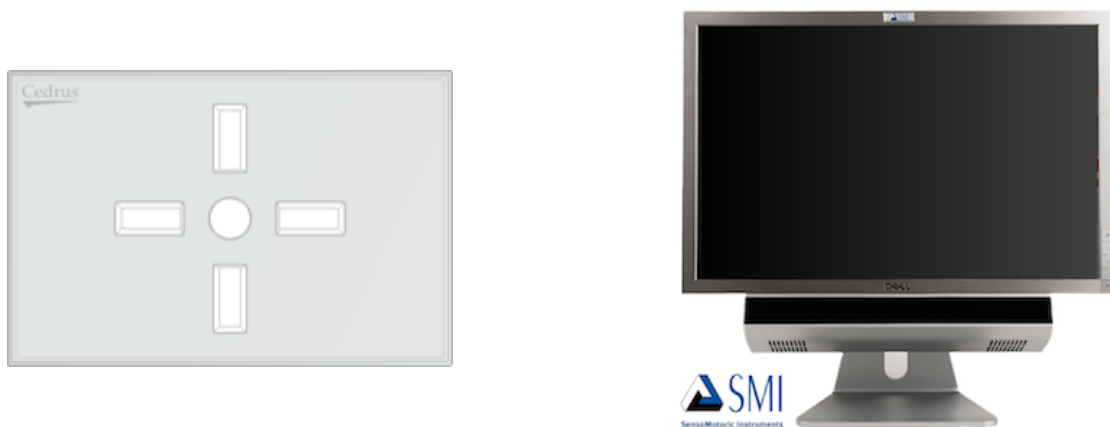
Figure 6.1 – À gauche : boîtier de réponses RB-530 (Cedrus); à droite : dispositif d'acquisition de données oculométriques RED500 (SensoMotoric Instruments)
