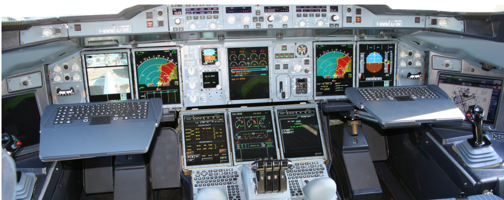
Figure 1.3 – Un siècle d'évolution dans le cockpit : de l'Albatros D-V à l'Airbus A-380, en passant par l'Antonov An-12. Le glass cockpit de l'Airbus A-380 traduit une volonté de réduire l'encombrement visuel, caractéristique de cockpits plus traditionnels comme celui de l'Antonov An-12.
