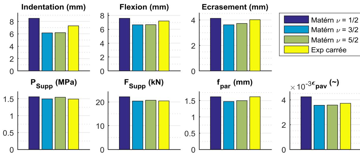
Figure IV-5 : Erreurs moyennes des différents modèles réduits en utilisant la méthode LOO
