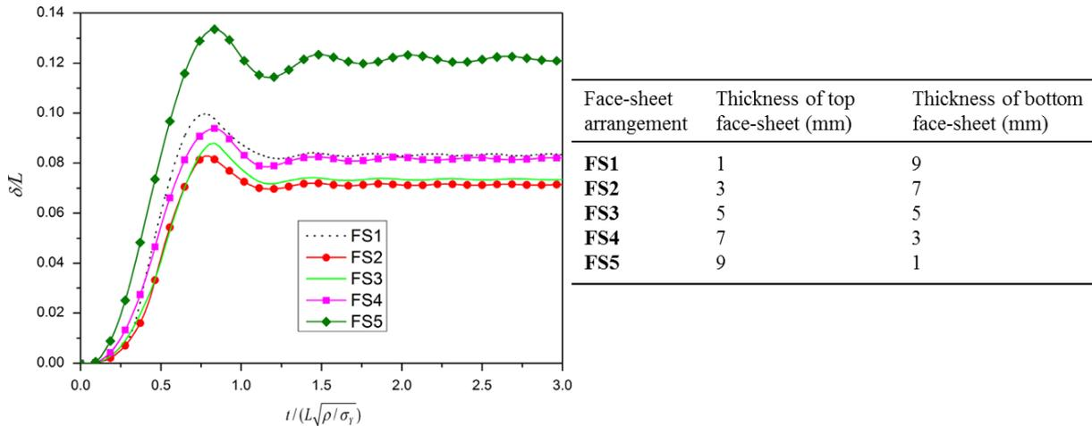
Figure I-23 : Évolution de la flèche arrière pour différents ratio d'épaisseur des peaux [Liu14]
