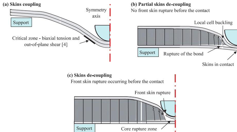
Figure I-20 : Effet de la hauteur de l'âme sur le comportement des peaux [Kolo13]
