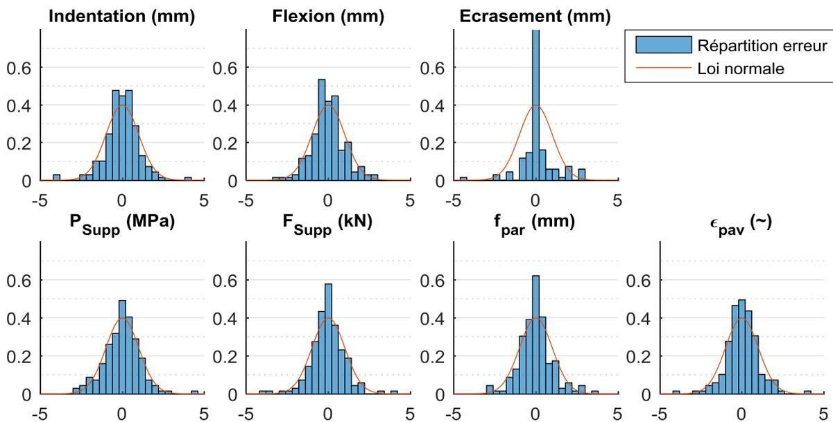
Figure IV-7 : Distribution des erreurs divisées par l'écart type estimé en utilisant la méthode LOO
