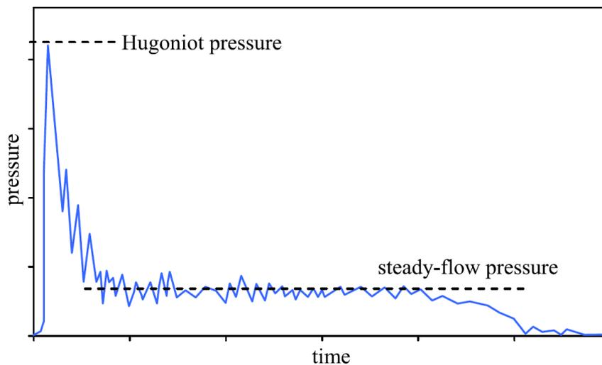
Figure I-3 : Courbe typique de pression au centre de la cible rigide [Heim11]
