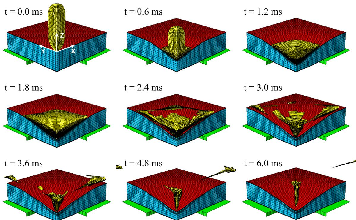
Figure II-4 : Sandwich de référence : déformation durant l'impact
