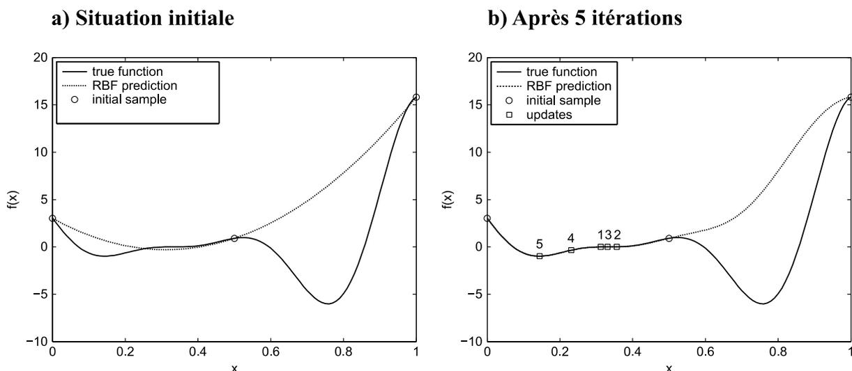
Figure I-34 : Optimisation avec un modèle réduit. Importance du modèle initial [Forr08]
