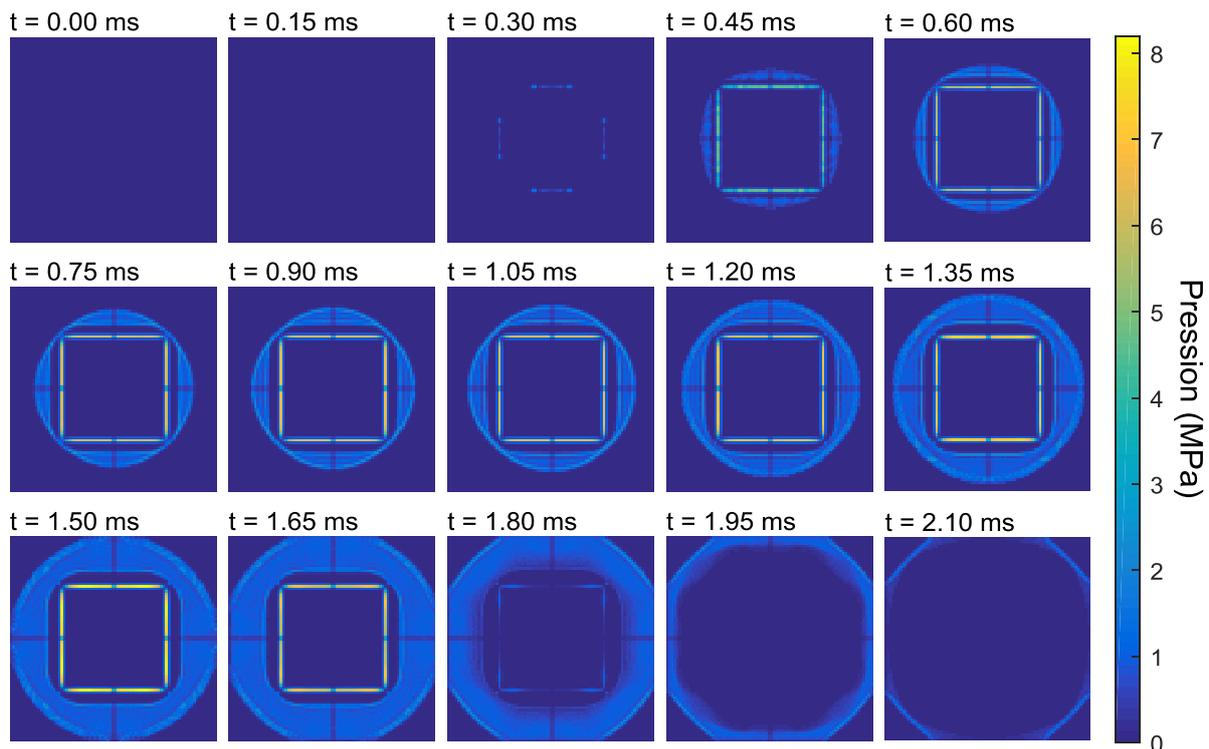
Figure II-7 : Sandwich de référence : pression de contact sur la peau arrière
