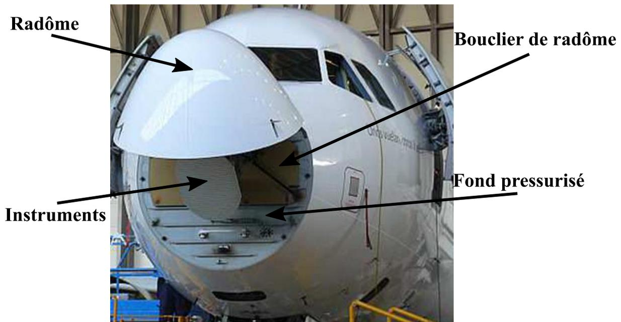
Figure 1 : Pointe avant d'un A320
