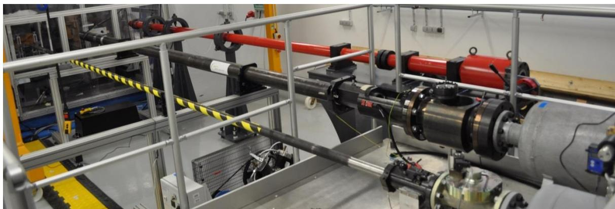
Figure A1-2 : Lanceur à gaz utilisé (au centre)
