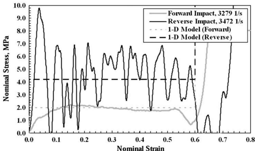
Figure I-17 : Effet d'onde de choc. Non-équilibre entre les deux faces de l'échantillon [Lee06]
