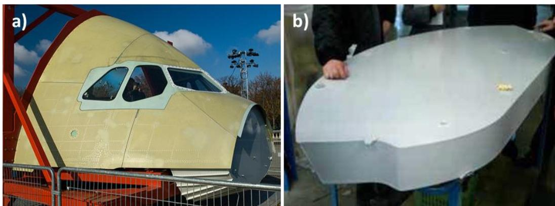
Figure II-1 : a) Pointe avant A350 b) Bouclier de radôme A350 [STELIA Aerospace]
