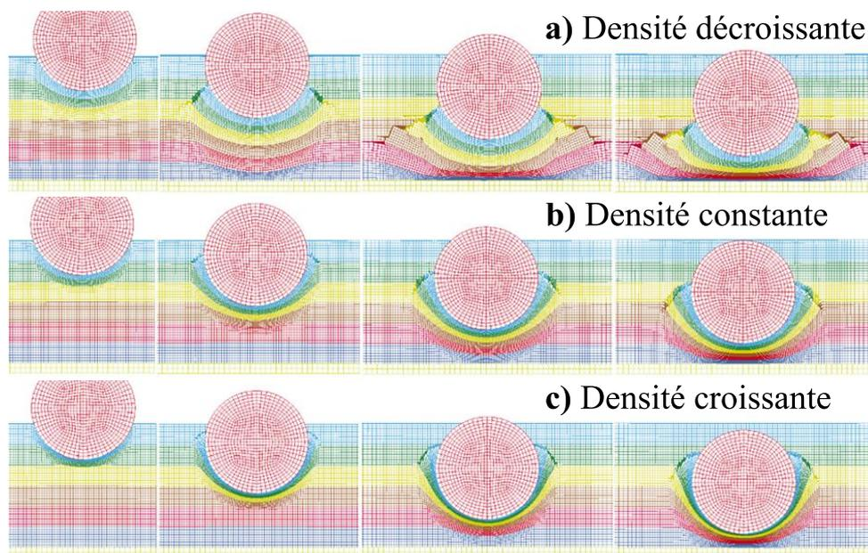
Figure I-21 : Optimisation du gradient de densité pour un impact dur [Zhan13]
