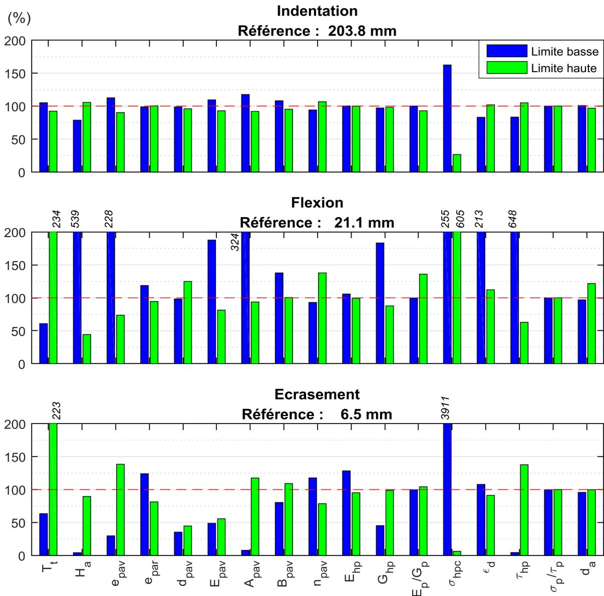
Figure III-1 : Résultats de l'étude de criblage : mesures des modes de déformée
