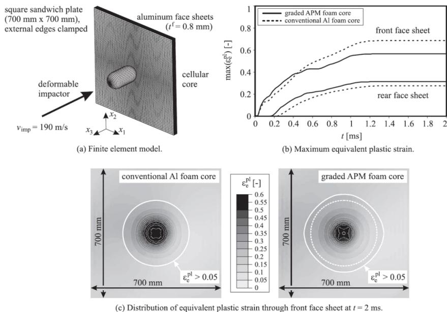
Figure I-10 : Étude de l'intérêt d'une âme à gradient de propriétés [Hohe12]
