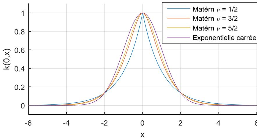
Figure IV-4 : Les quatre noyaux testés, avec une longueur caractéristique égale à 1
