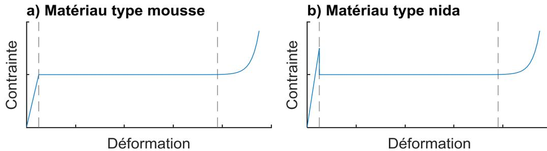
Figure I-12 : Courbes d'écrasement type des matériaux cellulaires
