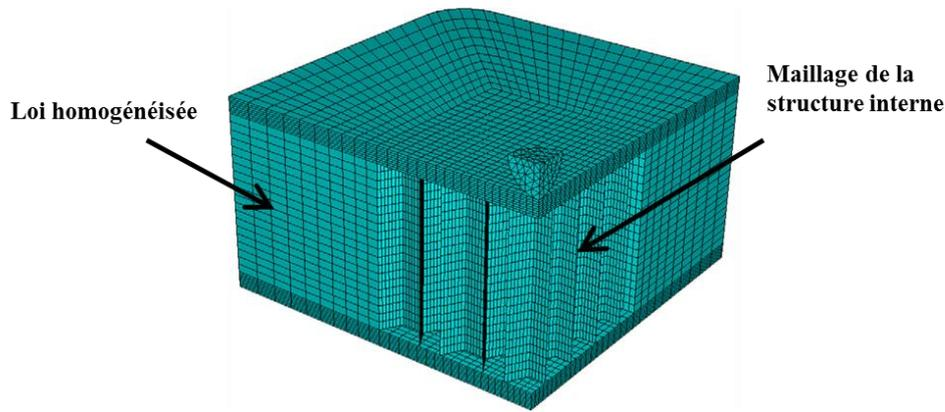
Figure I-13 : Modélisation fine dans la zone d'intérêt, homogénéisée autour [Buit10]
