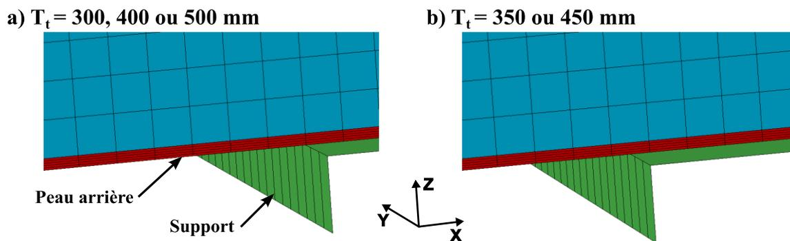
Figure III-11 : Zoom sur le contact entre la peau arrière et le support
