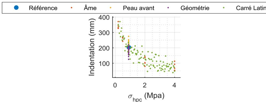
Figure V-4 : Corrélation entre l'Indentation et  $\sigma_{hpc}$
