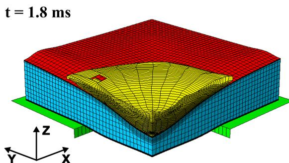
Figure III-8 : Plissement de la peau avant au niveau des plans de symétries pour le bouclier  $e_{pav} = 2 \text{ mm} / A_{pav} = 500 \text{ MPa}$
