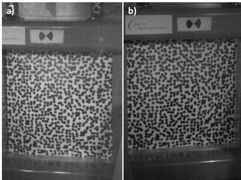
Figure A1-4 : Images des deux caméras de stéréo-corrélation
