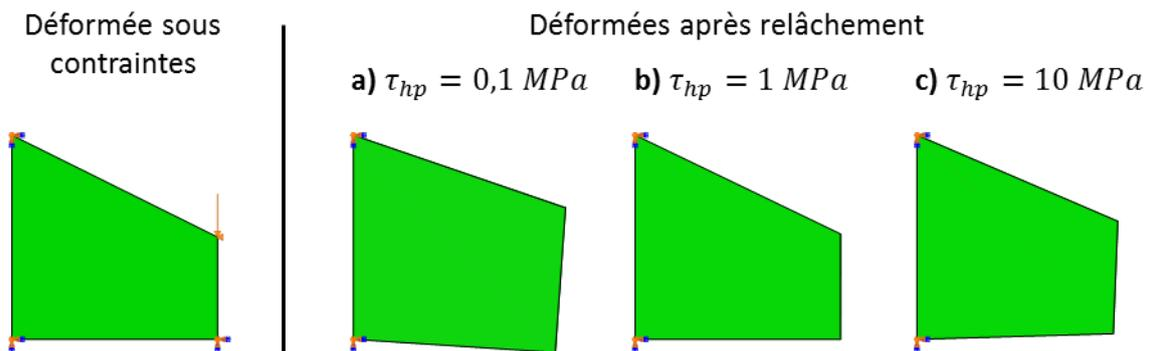
Figure II-3 : Déformées après relâchement en fonction de  $\tau_{hp}$ , avec  $\sigma_{hpc} = 1 \text{ MPa}$
