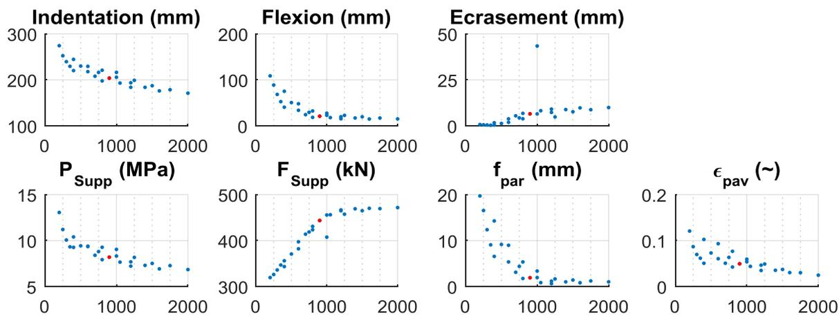
Figure III-6 : Variation des 7 sorties en fonction de  $e_{pav} * A_{pav}$ . Le point référence est indiqué en rouge
