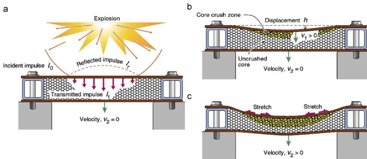
Figure I-22 : Chronologie de la déformation d'un sandwich sous blast [Dhar08]
