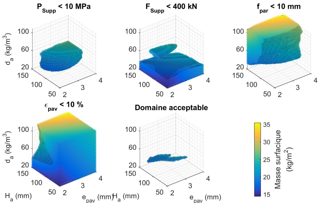
Figure V-9 : Visualisation du domaine acceptable, avec  $A_{pav} = 300$  MPa
