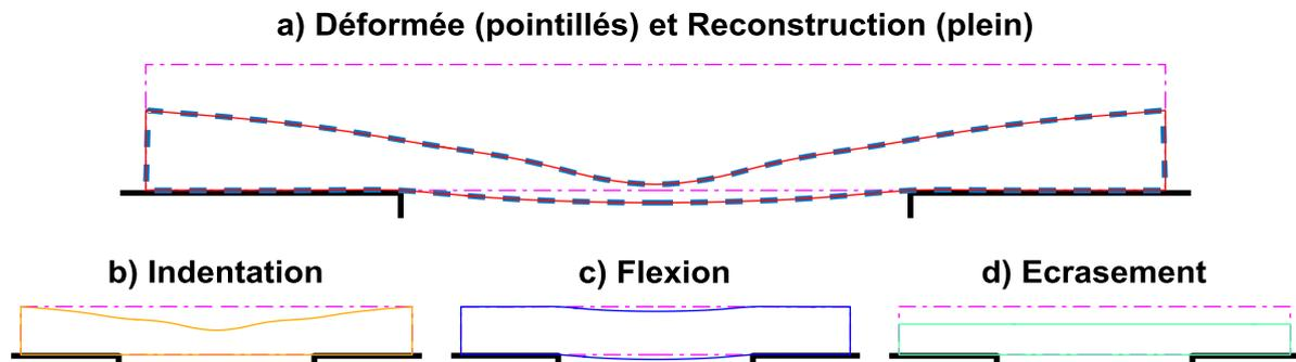
Figure II-11 : Décomposition de la déformée à  $t = 3$  ms du bouclier  $\sigma_{hpc} = 0.2$  MPa
