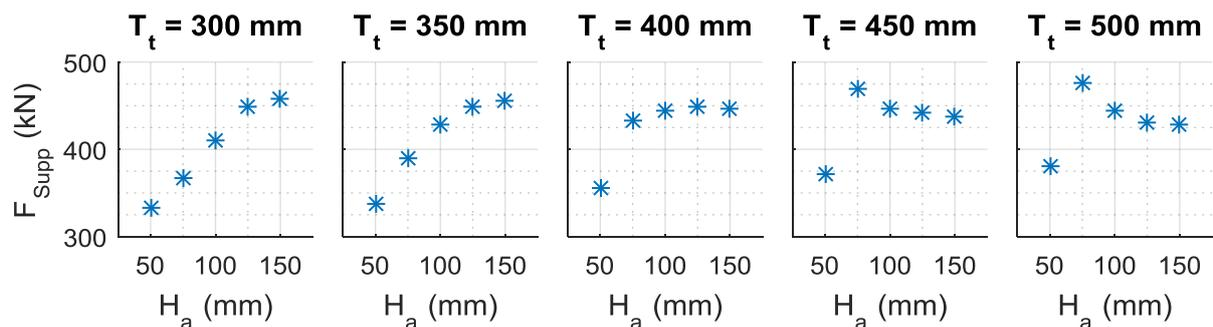
Figure III-12 : Évolution de l'effort maximal appliqué au support en fonction de la hauteur de l'âme
