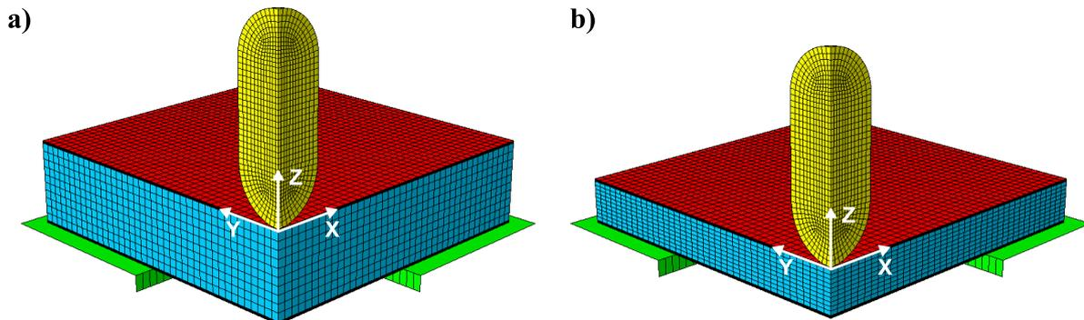
Figure II-2 : Modèles géométriques pour deux boucliers
