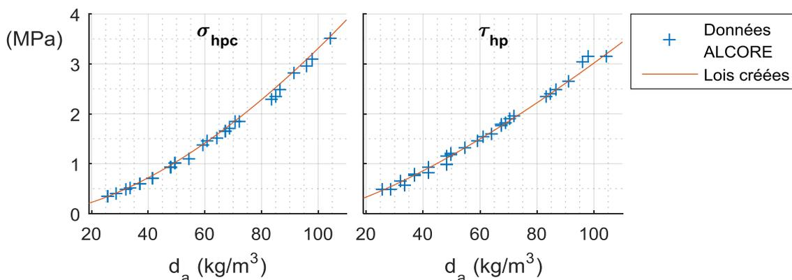
Figure V-8 : Approximation des données matériaux ALCORE pour le nida 5052
