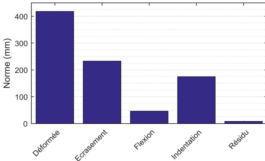
Figure II-12 : Normes des différentes composantes dans la déformée à 3 ms du bouclier  $\sigma_{hpc} = 0.2 \text{ MPa}$
