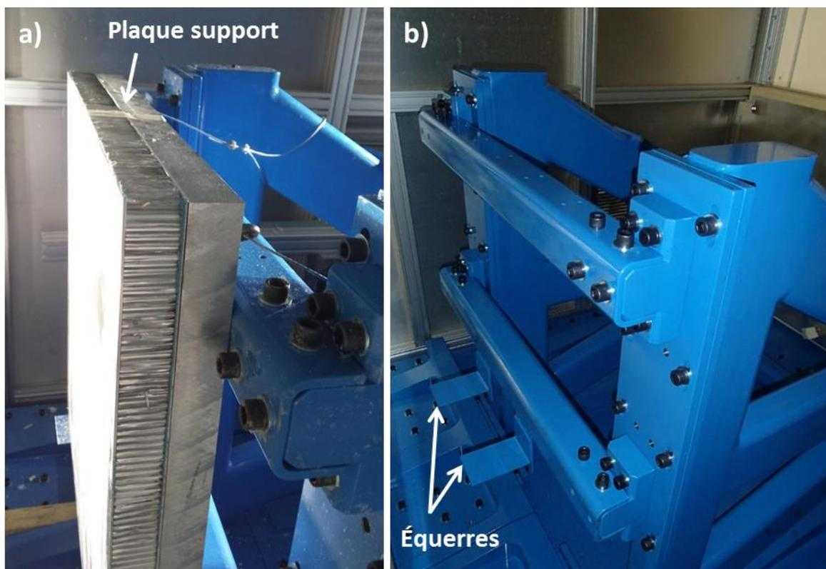
Figure A1-3 : a) Éprouvette 3 sur son support b) Bâti fixé au sol
