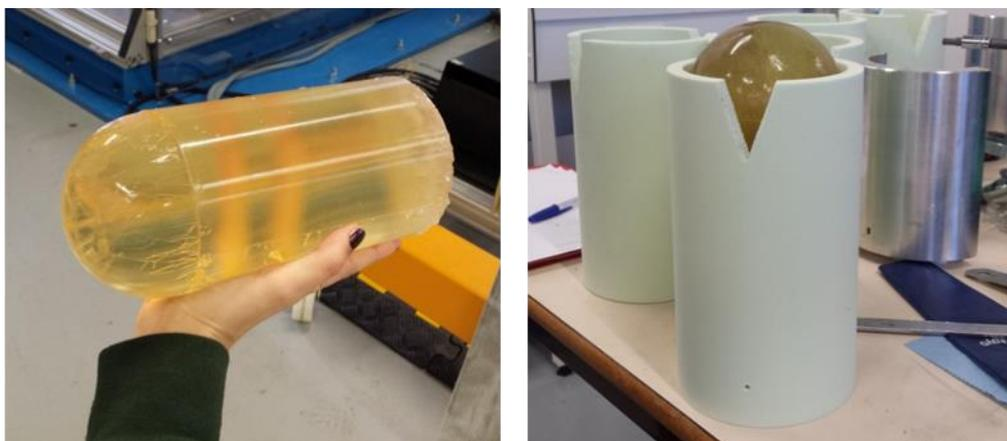
Figure A1-1 : a) Substitut en gélatine utilisé b) Substitut dans son sabot
