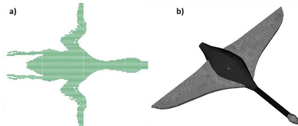
Figure I-8 : Géométries d'impacteurs plus complexes
