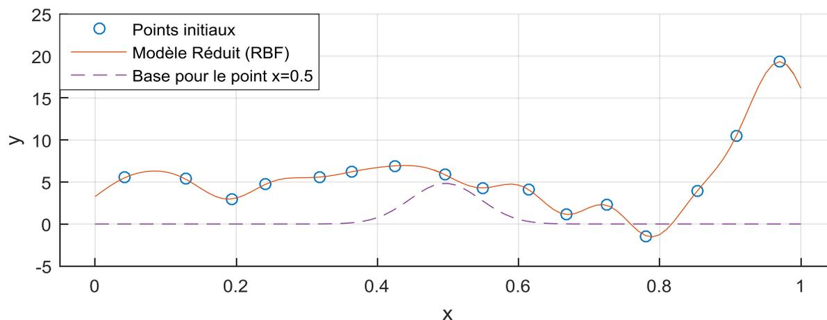
Figure I-32 : Modèle réduit à fonctions radiales : base Gaussienne
