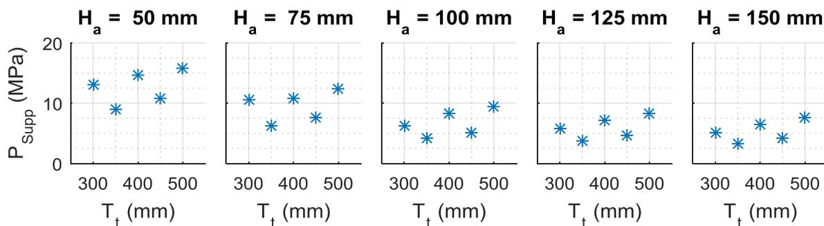
Figure III-10 : Évolution de la pression maximale appliquée au support en fonction de la taille du trou
