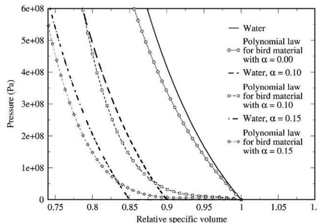
Figure I-9 : Équations d'état pour différentes valeurs de porosité [Airo06]
