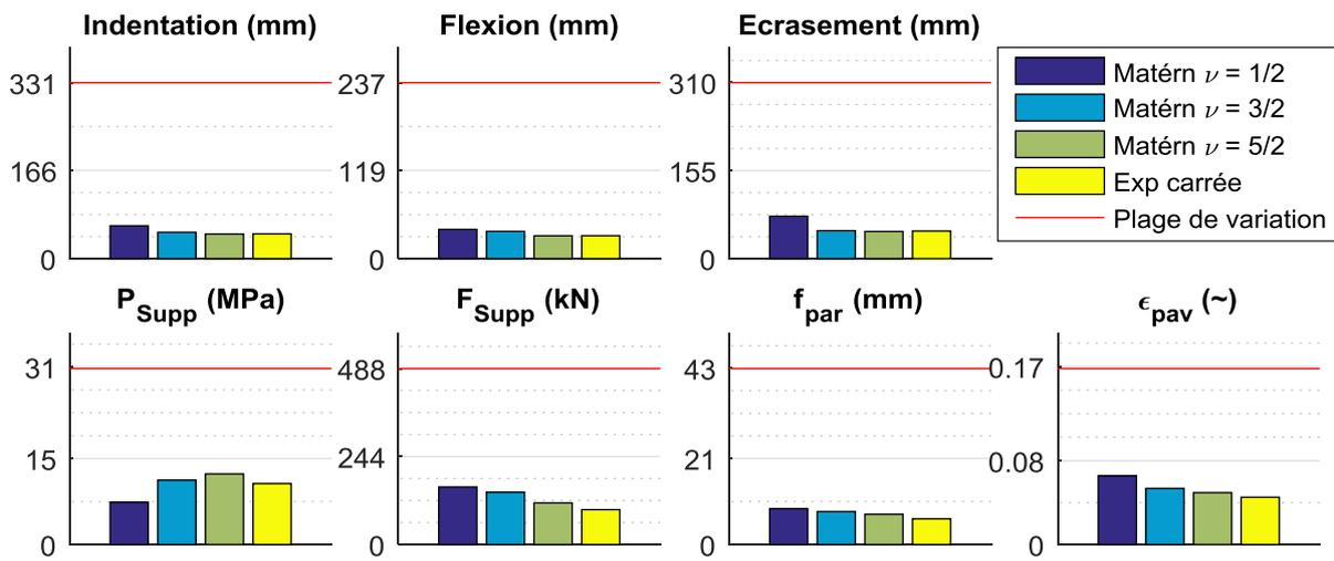
Figure IV-6 : Erreurs maximales des différents modèles réduits en utilisant la méthode LOO
