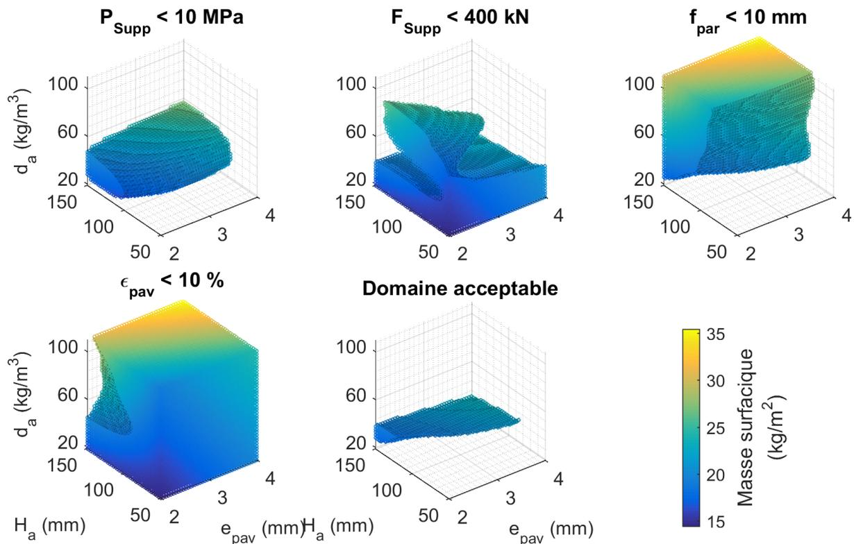
Figure V-11 : Visualisation du domaine acceptable à  $1\sigma$ , avec  $A_{pav} = 300 \text{ MPa}$
