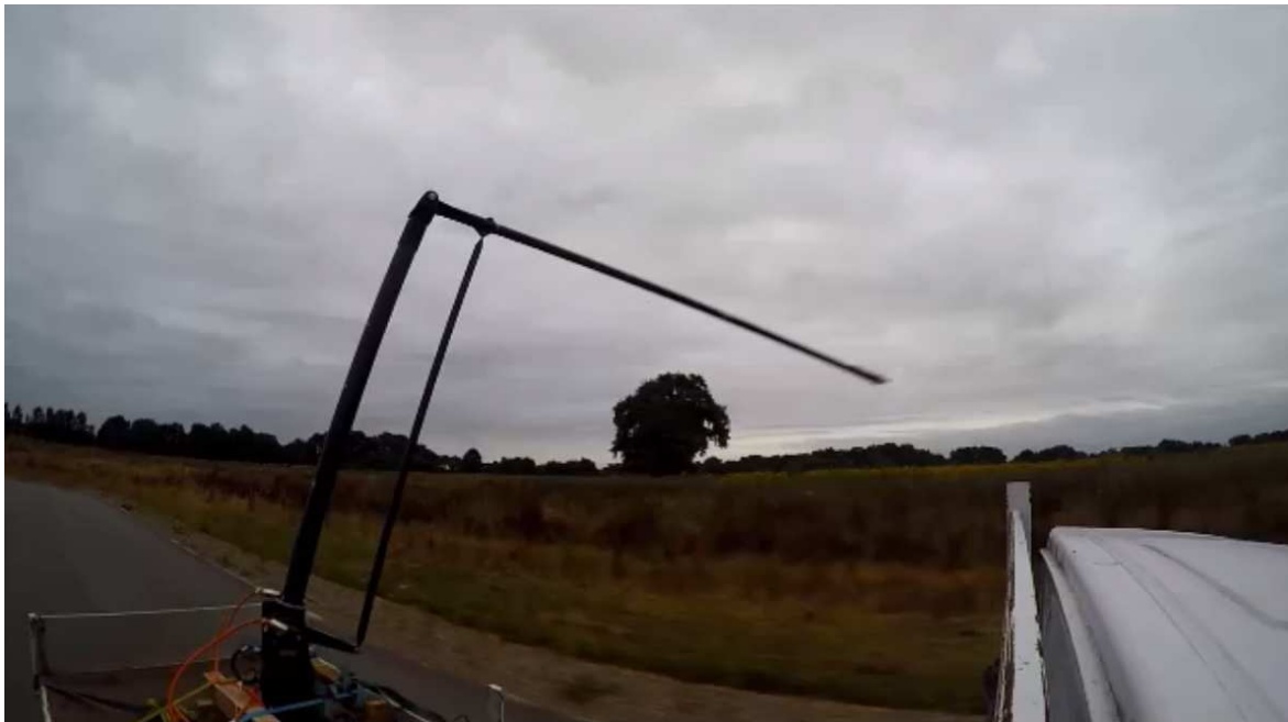
FIGURE 6.4 – Évaluation du comportement du bras YAKA sur un camion mobile.
