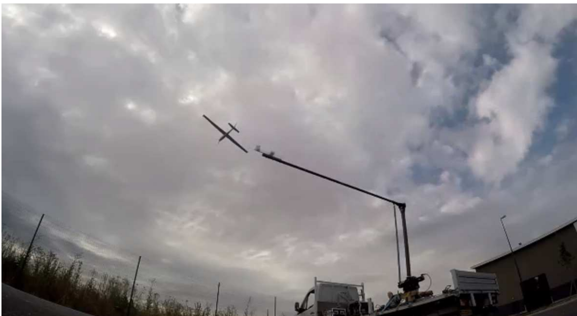
FIGURE 6.3 – Démonstration de lancement d'un UAV par le bras YAKA. vidéo : lancement.mp4
