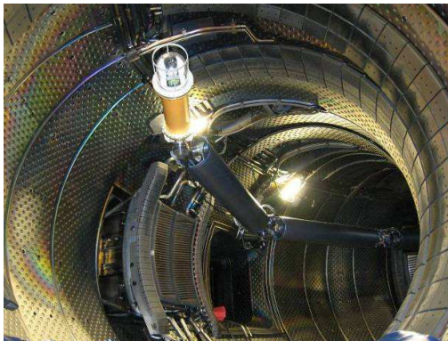
FIGURE 2.8 – Robot manipulateur flexible d'inspection nucléaire AIA GARGIULO et collab. [2008]. Ce robot mesure 8 mètres de long et possède 8 degrés de liberté pour une masse de 150kg.
