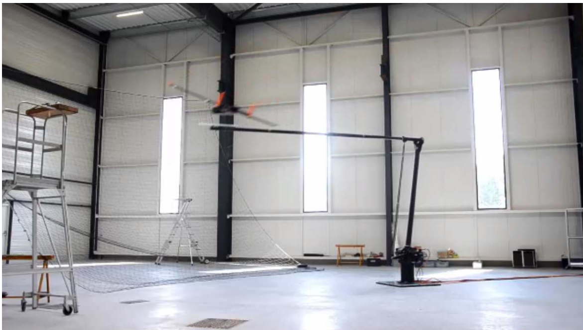
FIGURE 6.2 – Récupération d'un UAV non actionné lancé par une catapulte. vidéo : recuperation_indoor.mp4
