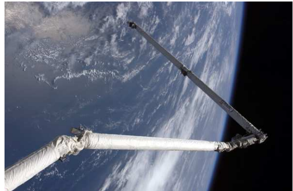
FIGURE 2.9 – Robot manipulateur spatial Remote Manipulator System (RMS) équipé de l'extension Orbiter Boom Sensor System . Ce système mesure 30 mètres, possède 6 degrés de liberté et pèse environ 500kg. Source : NASA (STS114-E-5330).
