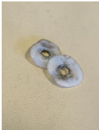
Figure 49 : Photographie des rondelles isolantes déformées du porte-échantillon
