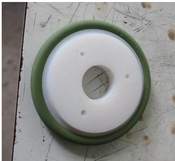
Figure 36 : Photographie de l'anneau de centrage en PTFE
