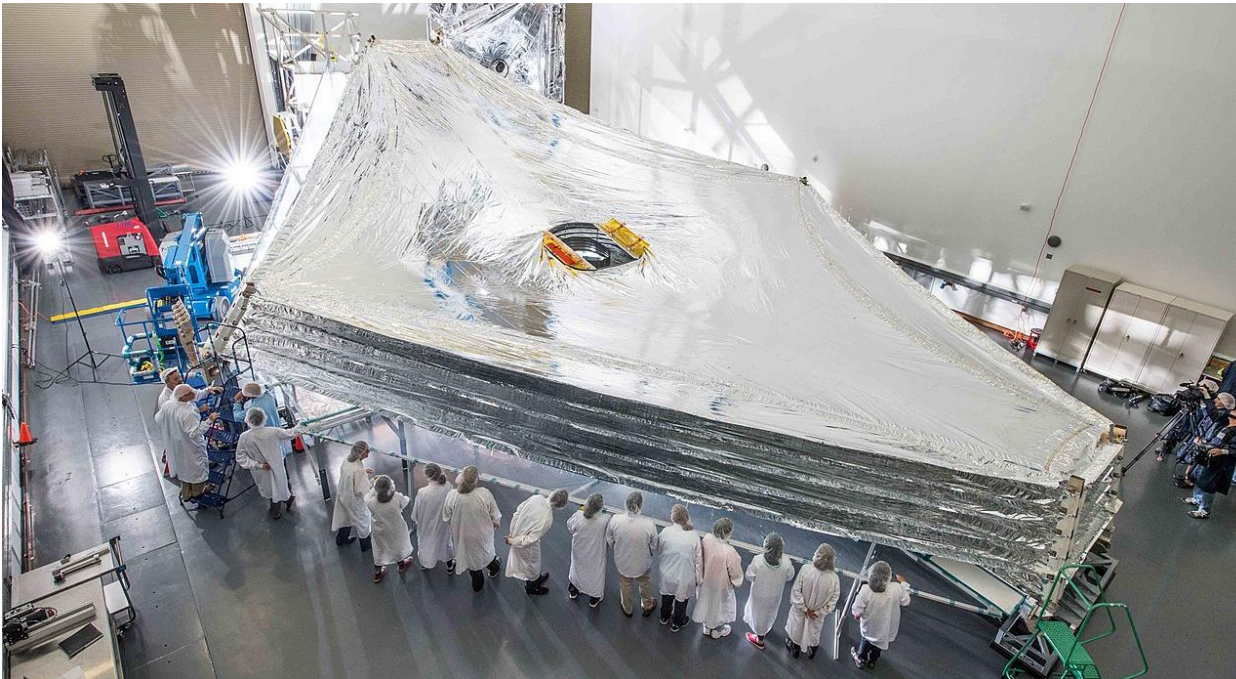
Figure 2 : Exemple d'application de type miroir, le Sunshield du télescope spatial James Webb (film de silicone dopé à l'aluminium sur ses deux faces) 13
