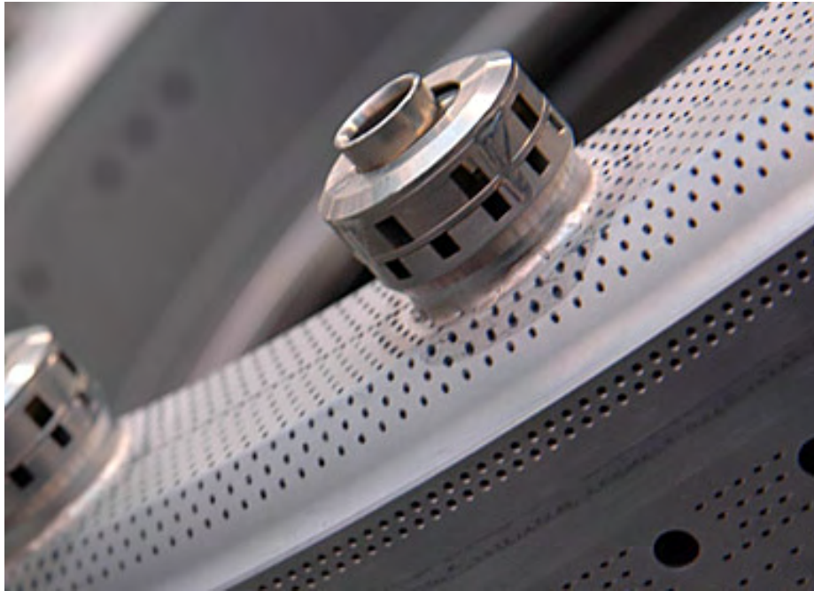
Figure I-4 : Exemple de paroi multipercée : chambre ARDIDEN, Turbomeca
