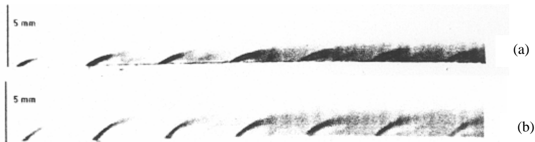
Figure II-10 : Visualisation longitudinale du film sur les rangées 1 à 13 (D'après Rouvreau [76]). a) M=0,8 et I=0,3 ; b) M=3,4 et I=5,2
